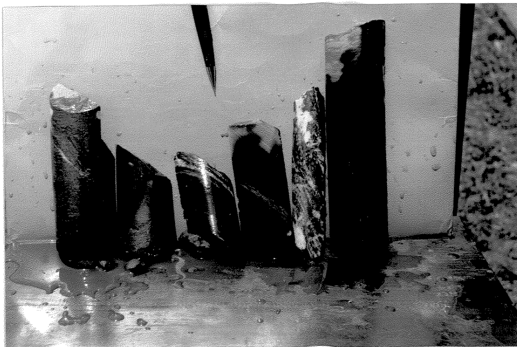
Foto 6.1: Níveis de sulfeto paralelos à laminação nos metarritmitos (BA 11-198,80 e 213,90: 3 e 4) e nódulo de sulfeto também paralelo à laminação (BA 11-300,85: 6).
