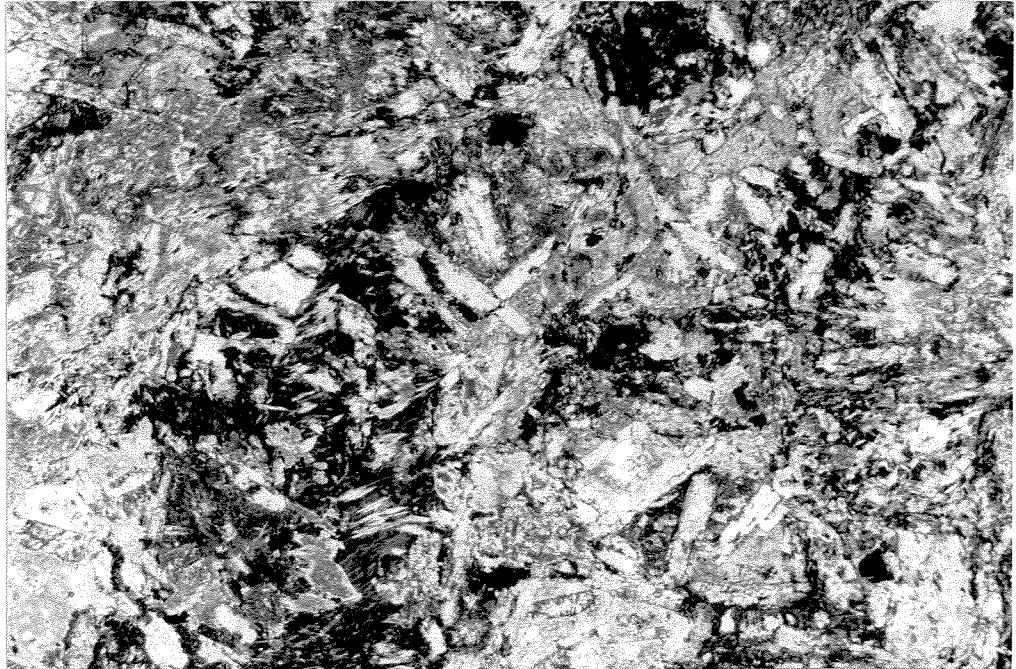
Foto 4.1: Metadiabásio com textura reliquiar suofítica, dada por ripas de plagioclásio incluídas em cristais maiores de anfibólio (BA 17-548,10). Nicóis cruzados; aumento: 25x.
