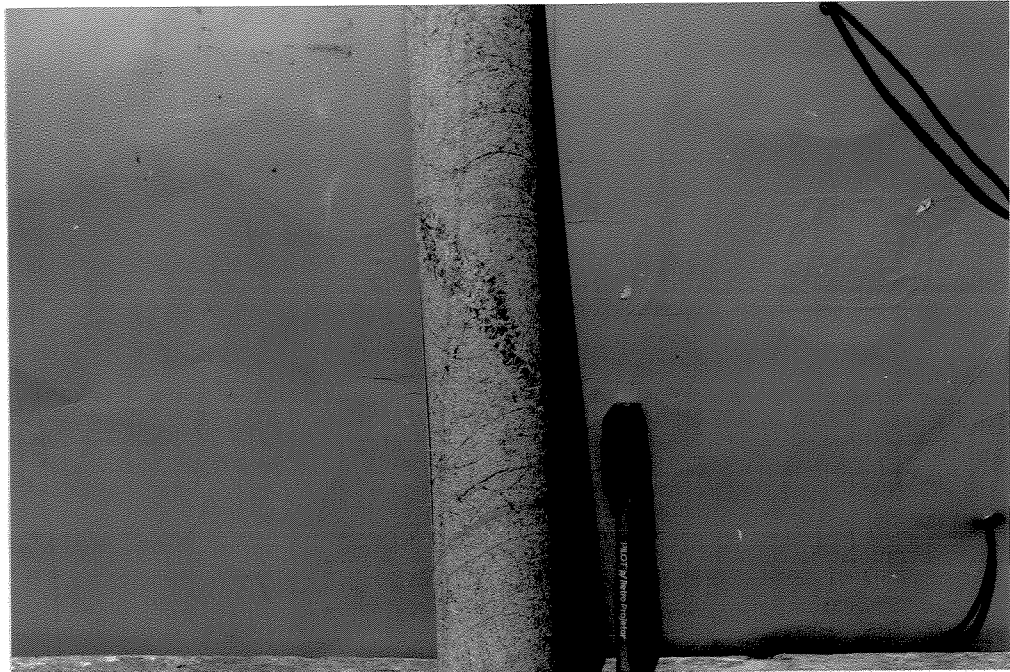
Foto 3.10: Rocha b̄sica intrusiva (diab̄sio) (BA 244-129,80).
