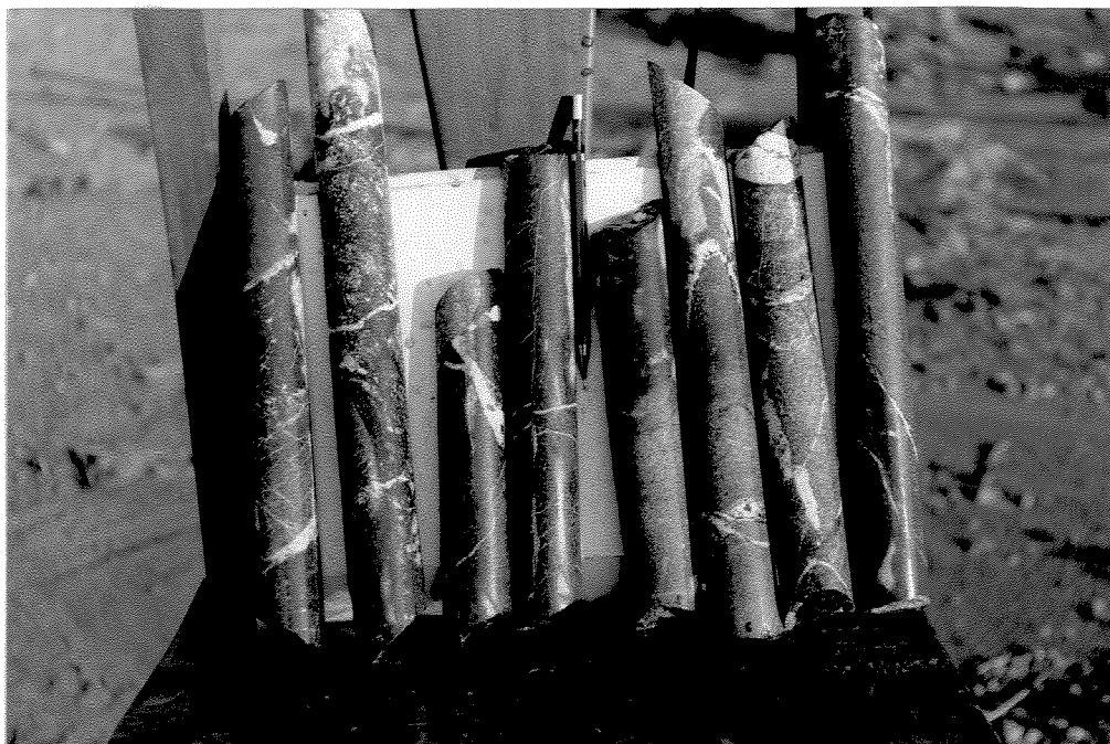
Foto 3.3: Metabasaltos e metadiabásios (Furo BA-17) apresentando diferentes estágios de alteração hidrotermal.
