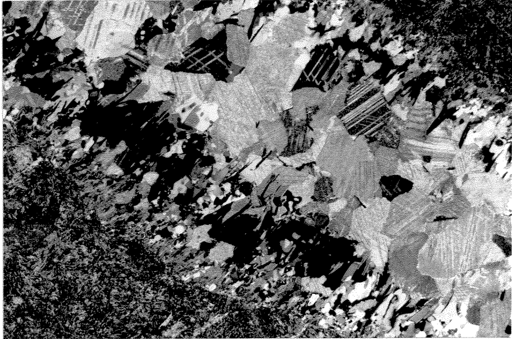
Foto 4.7: Vênula espessa e zonada, apresentando das bordas para o centro: biotita, clorita, quartzo e carbonato (BA 16-552,70). Nicóis cruzados; aumento: 25x.
