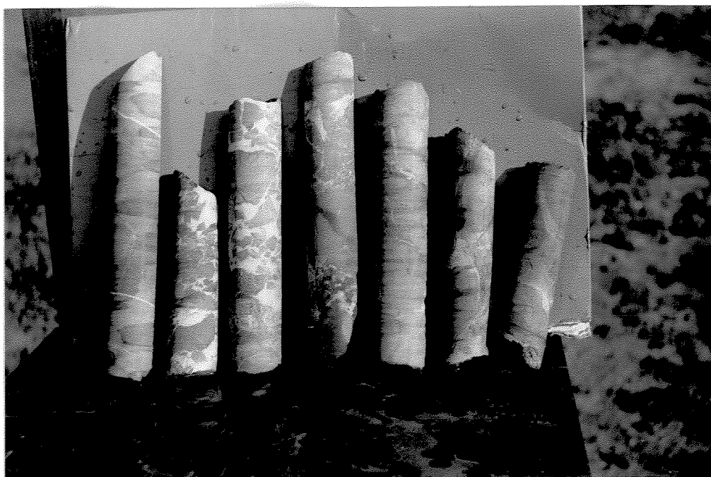
Foto 3.4: Meta-andesitos a metadacitos (Furo BA-16): maciços (1,5); brechados (2,3), brechado com sulfeto (4), venulados (6,7).
