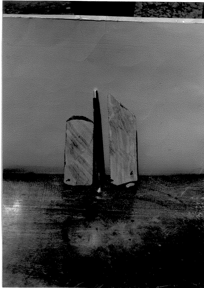
Foto 3.8: Metarritmito com lâminas deslocadas por microfalhas (BA 11-176,80 e 179,60).
