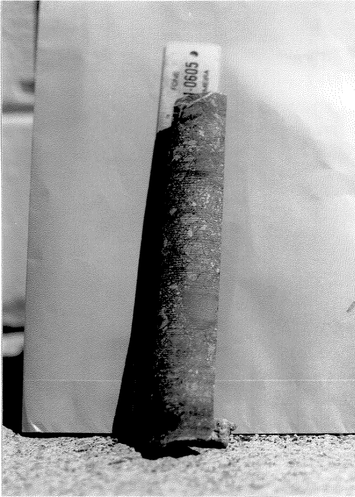
Foto 3.6: Brecha com fragmentos de diversos tamanhos em matriz clorítica (BA 16 - 376,30).
