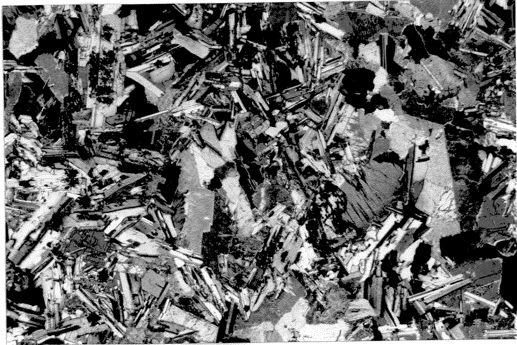
Foto 4.8: Rocha b̄sica intrusiva (diab̄sio) com textura of̄tica a subof̄tica (BA 244- 120,00). Nic̄is cruzados; aumento: 25x.
