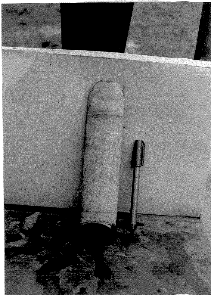
Foto 6.1: Níveis de sulfeto paralelos à laminação nos metarritmitos (BA 11-198,80 e 213,90: 3 e 4) e nódulo de sulfeto também paralelo à laminação (BA 11-300,85: 6).
