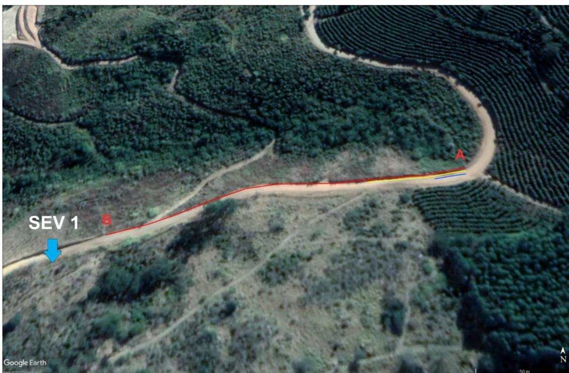
Figura 4 - SEV 1 e CE 1 (espaçamento= 1; 3 e 5m), A e B identificam, respectivamente, início e fim do CE.
