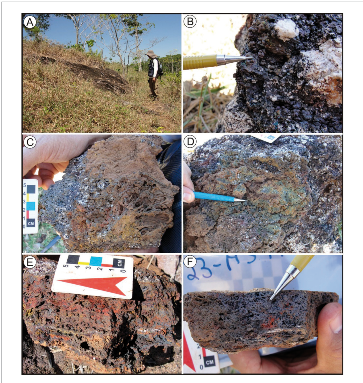
Figura 5.18 - A) afloramento em blocos de brecha (gossan). B) e D) boxwork com estrutura em célula, típica de sulfeto de zinco (esfalerita). C) boxwork com estrutura radial, típica de sulfeto de chumbo (galena). E) e F) veios de sulfetos maciços oxidados, boxwork com estrutura em clivagem, típico de sulfeto de chumbo (galena).
