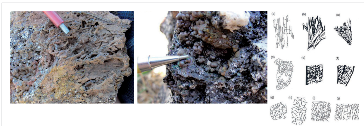
Figura 5.7 - Estruturas tipo boxwork encontradas nos gossans da região. O esquema à direita relaciona o tipo da estrutura residual com o sulfeto primário pré-existente – (a-c) galena (a-clivagem, b-mesh, c-radial); (d-e) esfalerita (d-esponja, e-celular); (f) calcopirita; (g-h) bornita; (i-j) tetraedrita. Retirado de Moon, Whateley e Evans (2006). As fotos apresentam semelhança com os exemplos da galena (b, c) e esfalerita (d, e).
