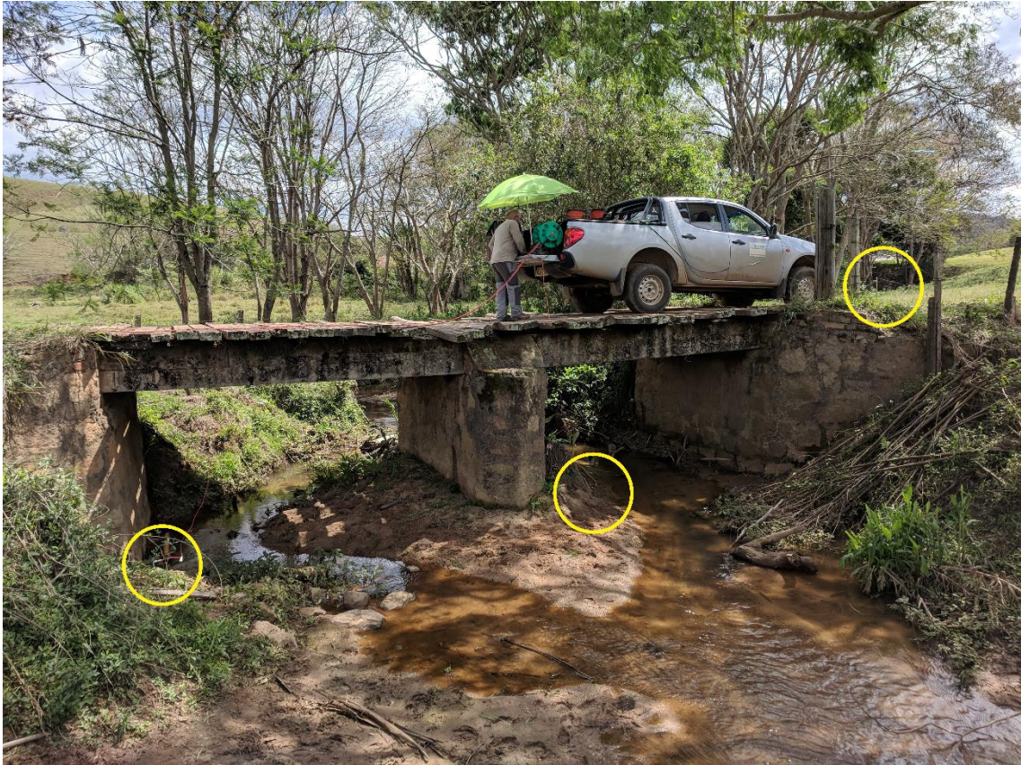
Figura 11 - Caminhamento elétrico sobre ponte. Contorno amarelo sobre posições dos eletrodos.
