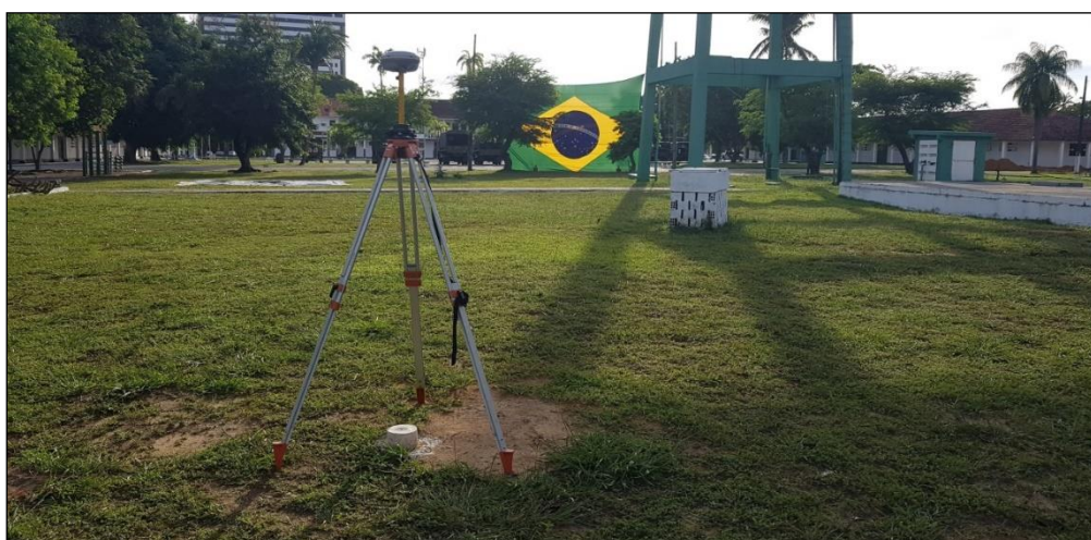
Figura 3. Estação de referência instalada no exército
