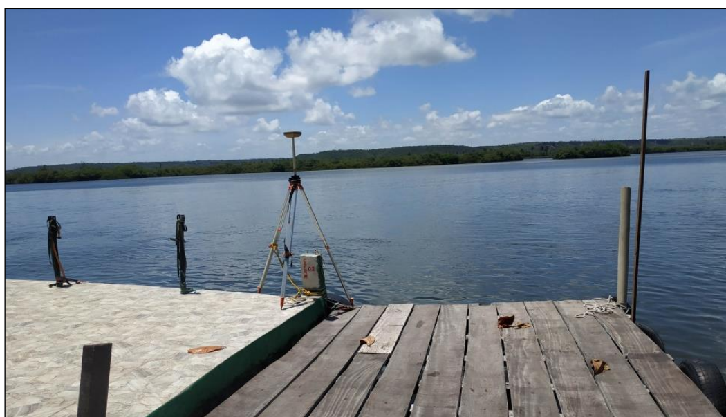
Figura 9. Ocupação com GPS nas referências batimétricas na Lagoa Mundaú
