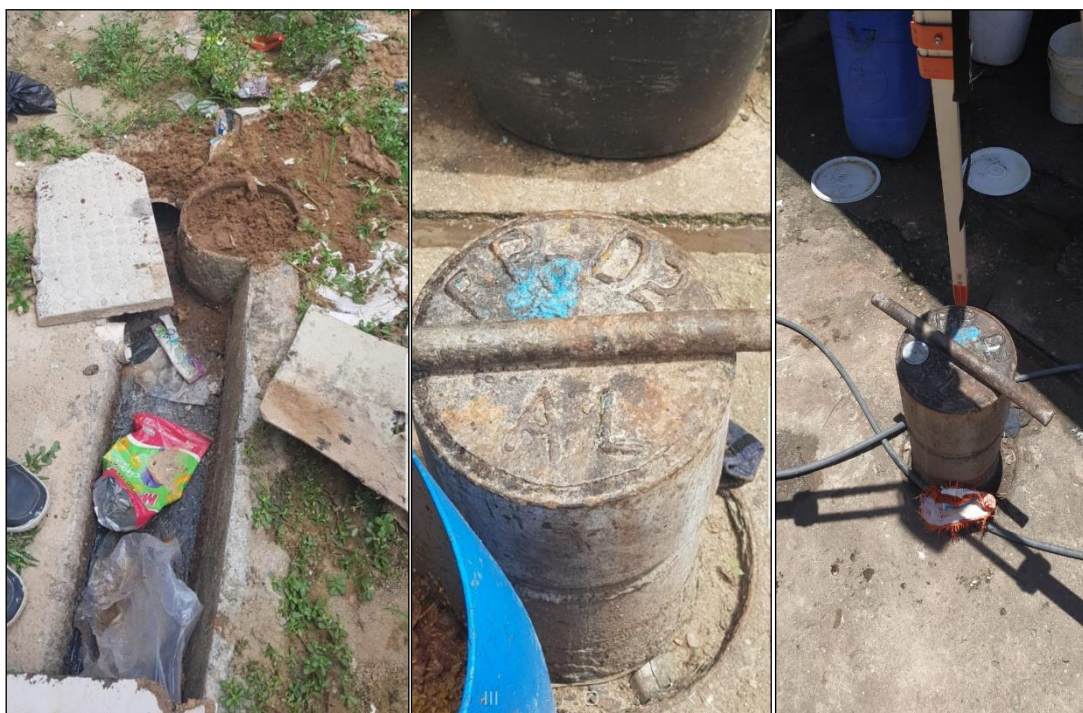
Figura 8. Identificação dos poços antigos de sondagem da Petrobrás
