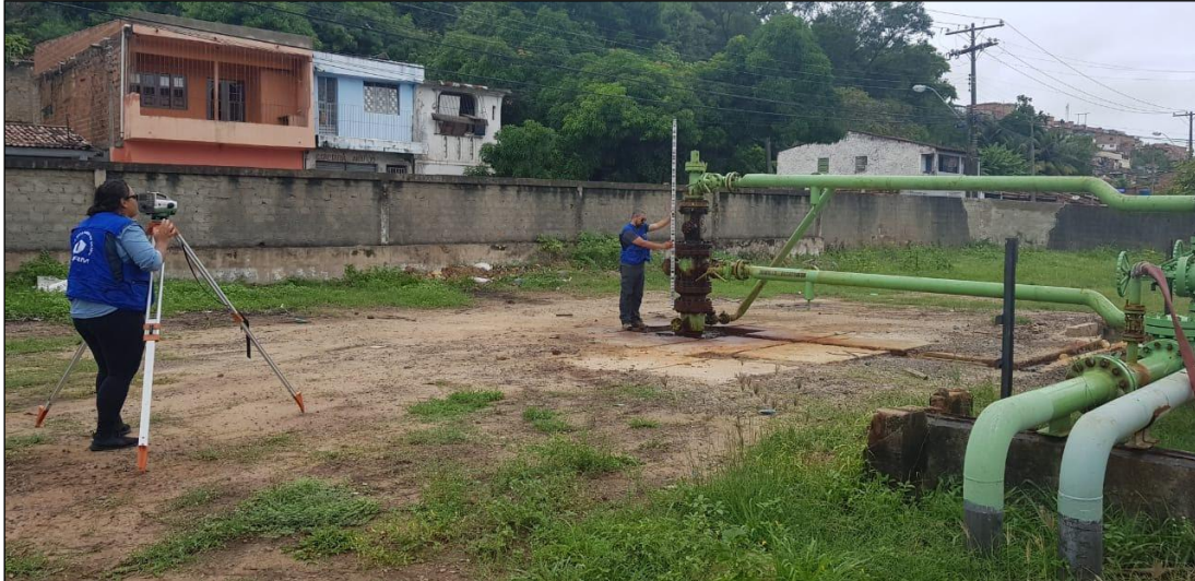
Figura 9. Nivelamento geométrico utilizando a boca da mina como leitura de VANT.
