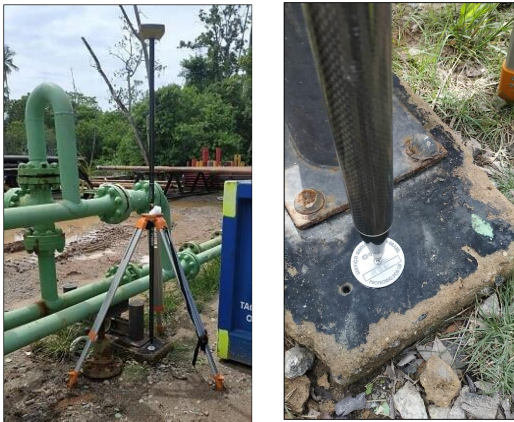
Figura 5. Obtenção das coordenadas planialtimétricas das RRNN instaladas
