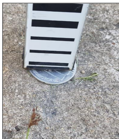
Figura 6. Ocupação com a mira para a realização do nivelamento
