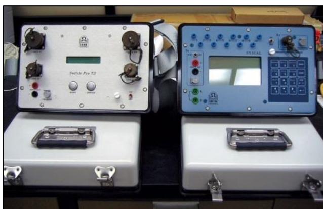
Figura 3. Equipamentos utilizados para levantamento geofísico elétrico: à direita resistímetro Syscal Pro e à esquerda o comutador Switch Pro 72.
