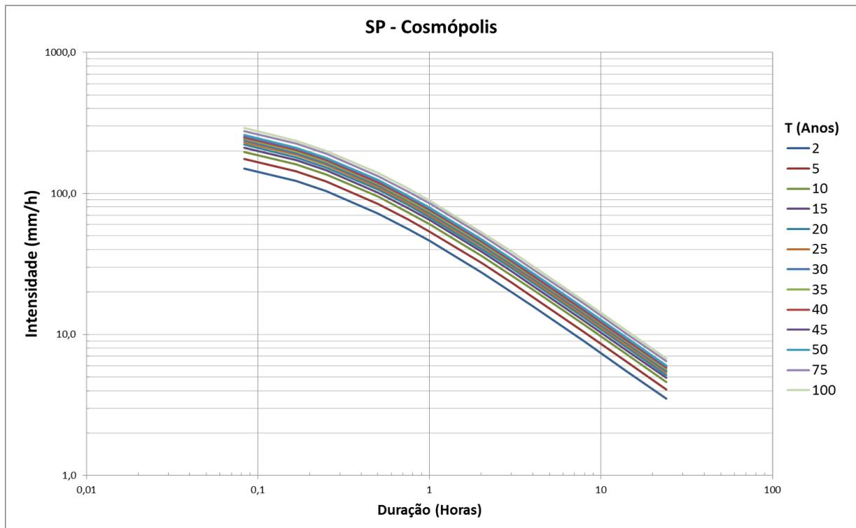
Figura 02 – Curvas intensidade-duração-frequência
