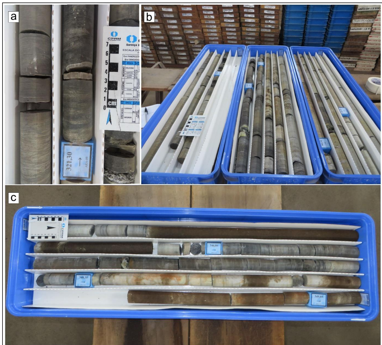
Figura 5. Fotografias dos testemunhos de sondagem realizados na BHRA em 1978 e armazenados na CPRM (litoteca de Caçapava do Sul). a Detalhe de parte do testemunho de sondagem SCARASC09 com fraturas preenchidas de gipsita; b Testemunho de sondagem SCARA10; c Testemunho de sondagem SCARA14.
