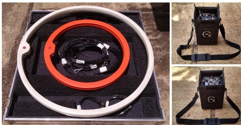
Figura 6: Condutímetro EM34-3XL usado para realizar leituras diretas da condutividade aparente do subsolo. No lado esquerdo a imagem mostra as bobinas e os cabos. No lado direito as imagens mostram os consoles do Transmissor e do Receptor.
