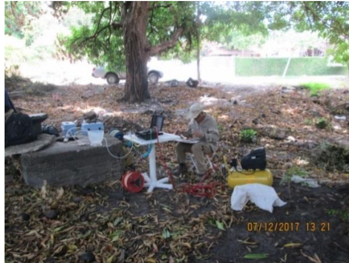
Figura 1. 5 - 3ª campanha de coleta de água através do Método LOW-FLOW (baixa vazão) no poço Açai2 - RIMAS. Período seco. Dezembro de 2017.
