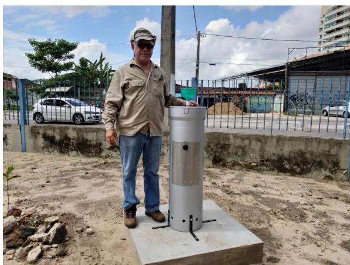
Figura 1. 9 - Instalação da GNIP-BE, com o amostrador de água de chuva. 13/12/2018.
