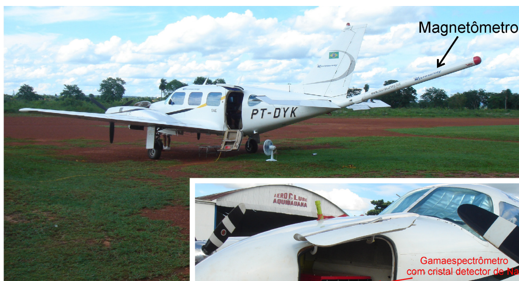
Fotografia 1 - Avião equipado com magnetômetro do tipo vapor de césio montado na cauda da aeronave (tipo stinger). Este magnetômetro mede o campo magnético total a cada 0,1 s.
