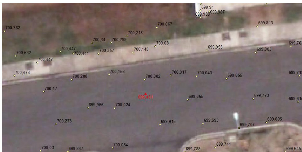
Figura 3 - Valores altimétricos no entorno do ponto cotado de identificação 3292. Fonte: Elaborado pela autora.
