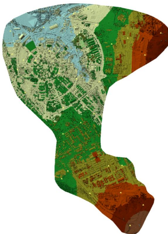
Figura 6.45 - Localização dos pontos levantados em campo (pequenos triângulos) sobre a TIN obtida por pontos LiDAR e colorizada de acordo com faixas hipsométricas. Fonte: Elaborado pela autora.
