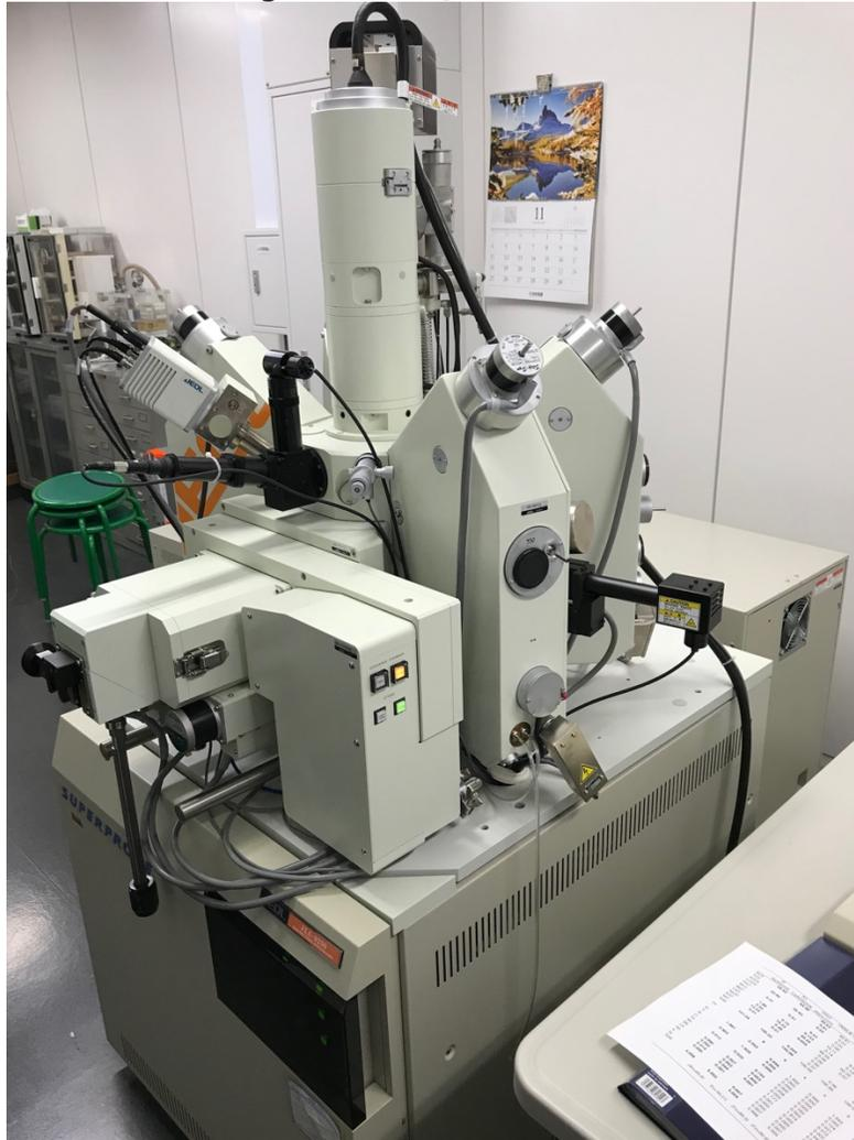
Foto 6 – Microscópio Eletrônico de Varredura utilizado para o imageamento dos zircões
