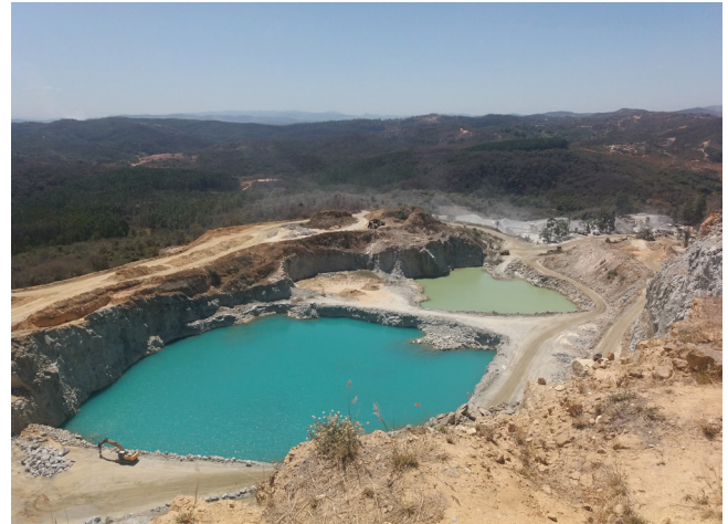
Figura 6.4 - Mina de grande porte em gnaiss, para produção de brita, blocos de rocha, areia residual (em manto de alteração) e areia industrial (ponto 64 – Santa Luzia).
