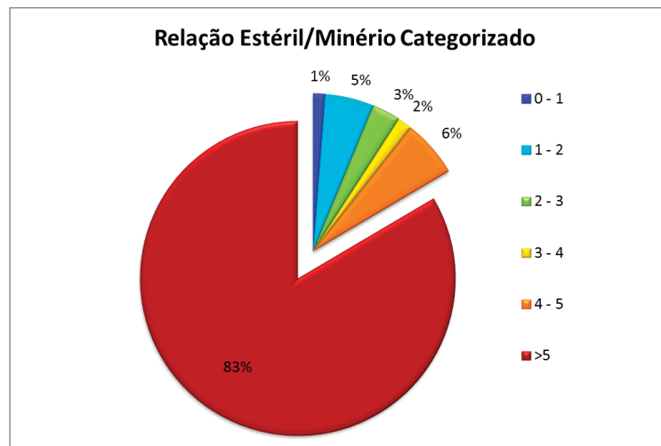
Figura 18.14 - Proporção da participação de cada categoria de relação estéril/minério em função do total de recursos calculados no bloco Sul.
