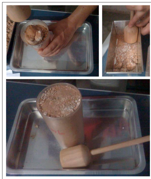
Figura 11.12 - Modo de preparação de amostras friáveis.
