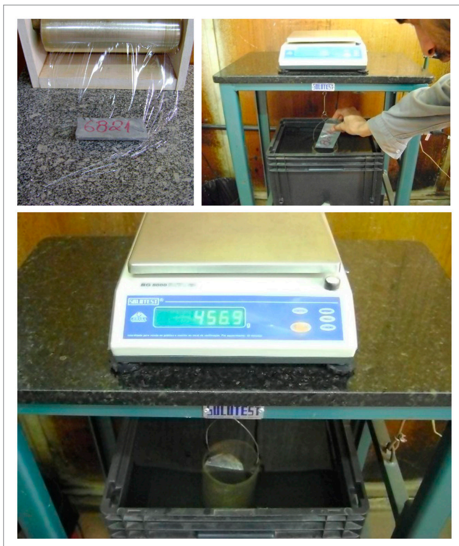
Figura 11.13 - Modo de preparação de amostras compactas.
