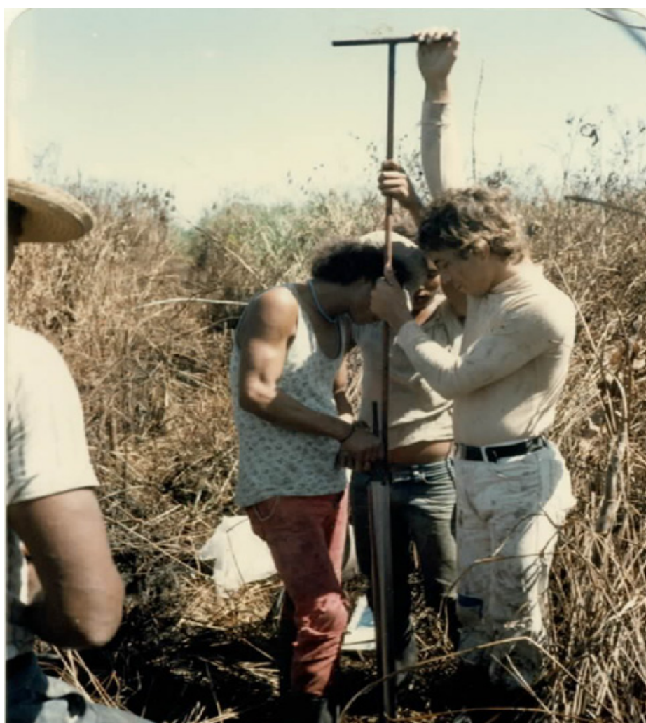
Figura 4.3 - Introdução de amostrador a pistão durante a perfuração de camada de turfa na área do depósito de Sutar. Fonte: CPRM, 1987.
