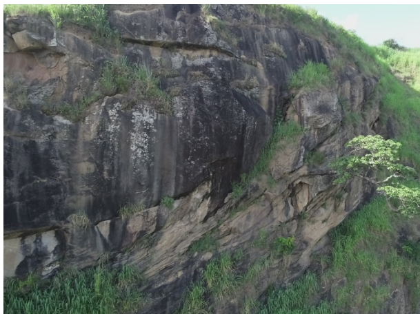
Figura 7. Descontinuidades com raízes de vegetação na face natural do maciço rochoso.
