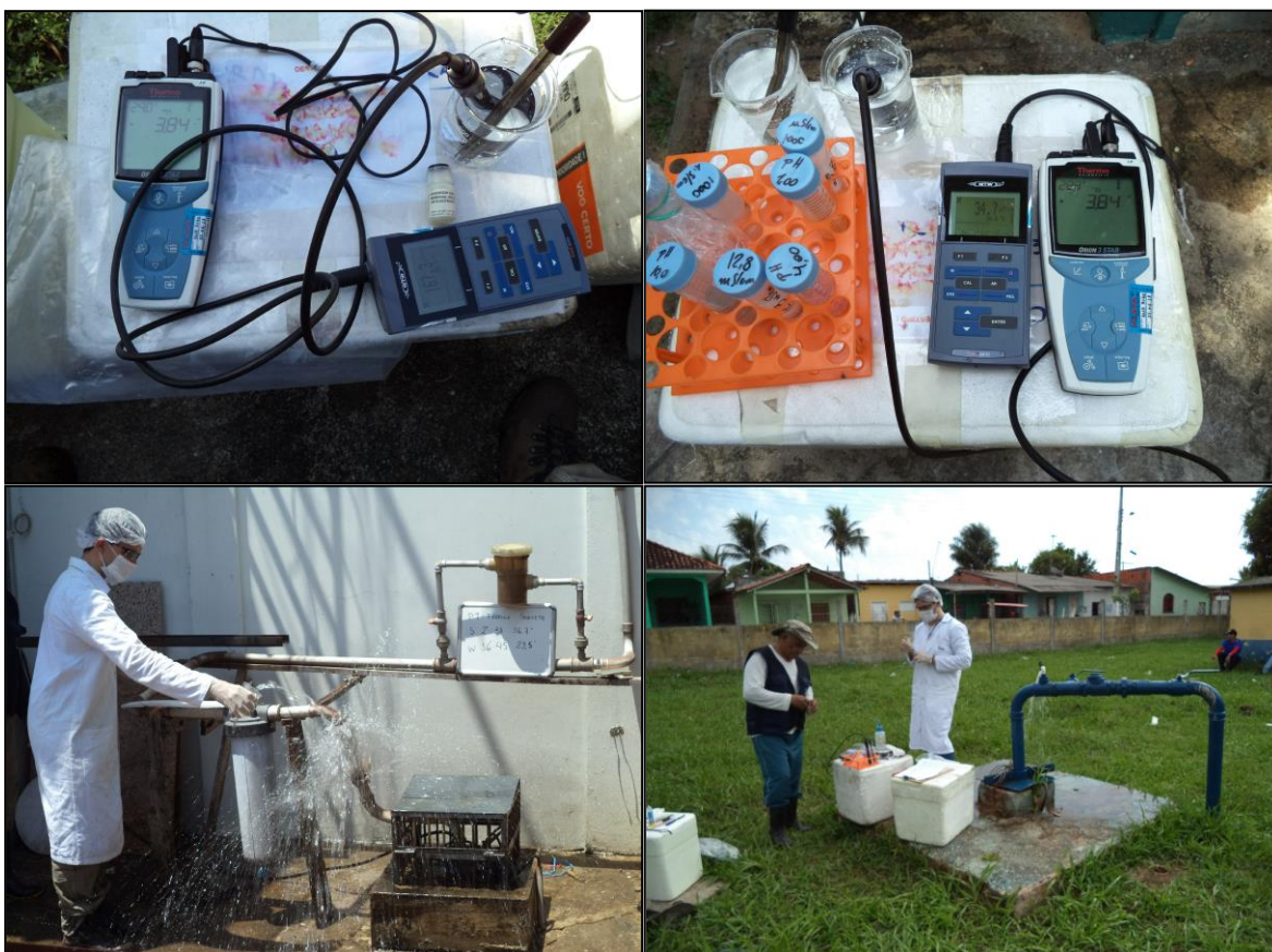
Figura 20: Acima, medição de pH e condutividade elétrica em amostras dos poços PT-10 e da UEA; abaixo, amostragem no poço da Fábrica de Sorvetes e filtragem de amostra do poço PT-03.
