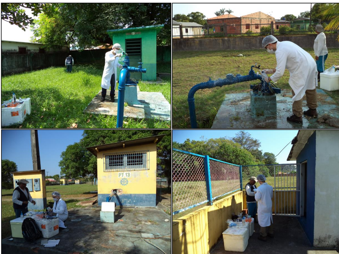
Figura 21: Acima, esterilização de torneira, com álcool, para coleta de amostra para análise bacteriológica no poço PT-06 e amostragem para bacteriologia no poço PT-16; abaixo, preparação das amostras coletadas nos poços PT-13 e do Condomínio Vila Cristina.
