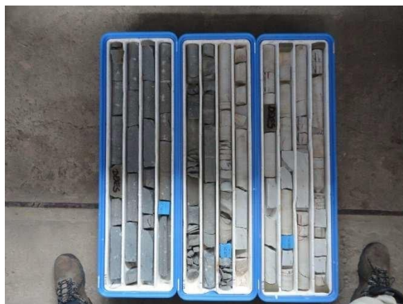
Figura 3.2 - Caixas plásticas com testemunhos de sondagem.
