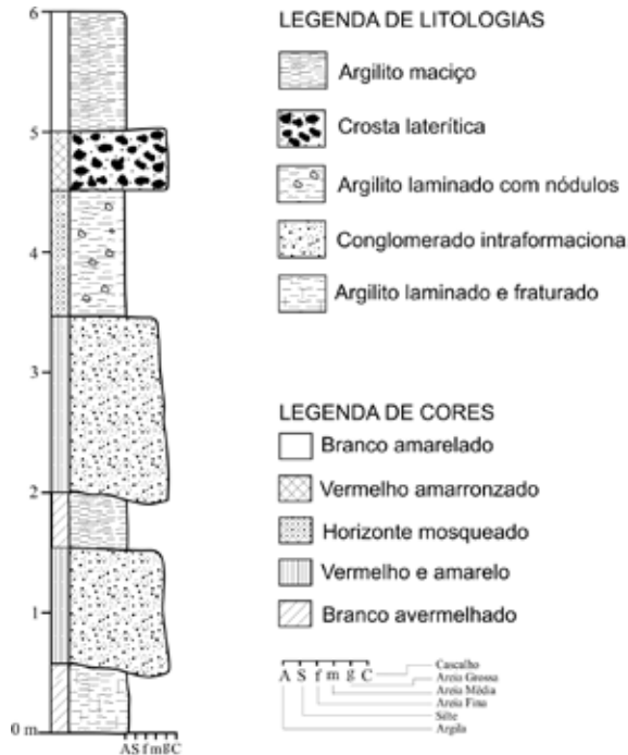
Figura 3.50 – Perfil litoestratigráfico da Formação Ipixuna. Afloramento EM-183.
