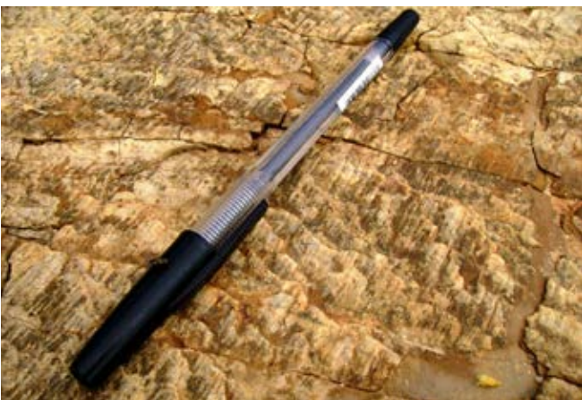
Figura 5.13 – Slickensides em espelhos de falhas nos arenitos da Formação Tucuui.
