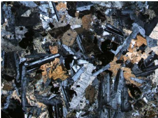
Figura 3.33 – Textura subofítica em dolerito do Diabásio Rio Pajeú. 20X.
