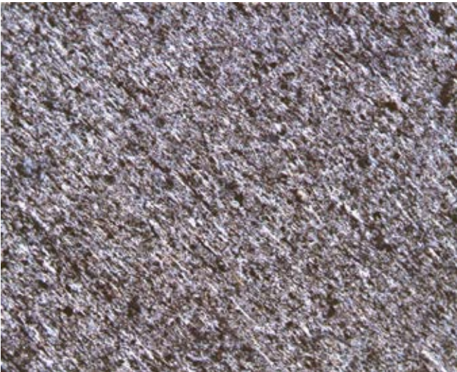
Figura 3.37 – Ardósia da Formação Couto Magalhães com textura lepidoblástica. Aumento 200X.
