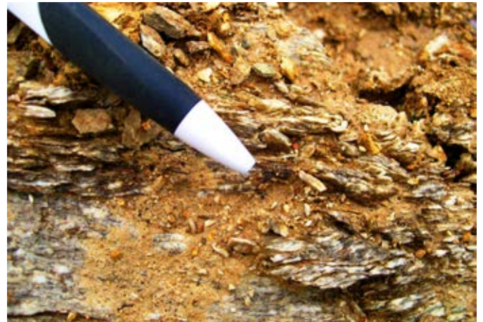
Figura 3.14 – Xistos máficos do Grupo Três Palmeiras/Formação Itatá exibindo foliação milonítica S-C com assimetria dextral.
