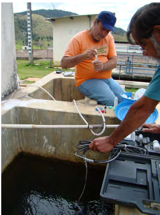
Foto 14 - Medição dos parâmetros físico-químicos e coleta de amostra de água numa ETA.
