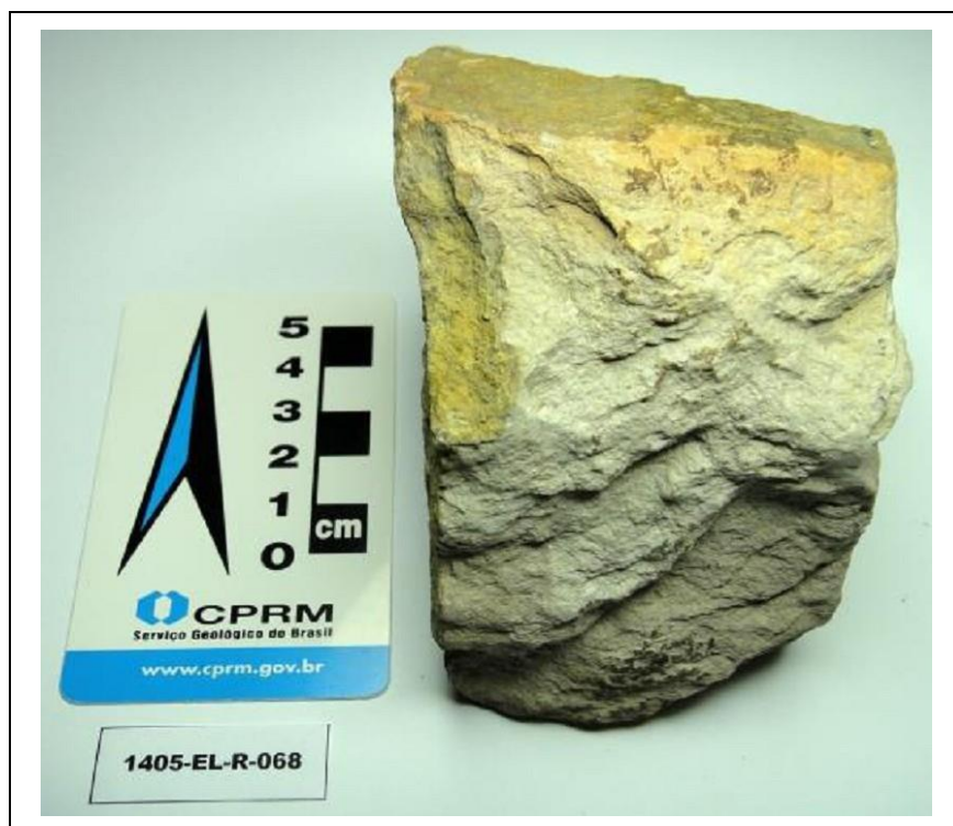
Figura 7 – Exemplo do tamanho de uma amostra coletada no campo, visando estudos espectrorradiométricos.
