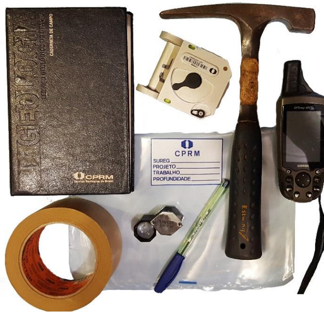
Figura 1 – Alguns dos equipamentos utilizados no campo na identificação, descrição e coleta de amostras de rocha: caderneta de campo, saco plástico, lupa de aumento (10x ou mais), fita gomada, martelo estratigráfico, caneta permanente, bússola e GPS.
