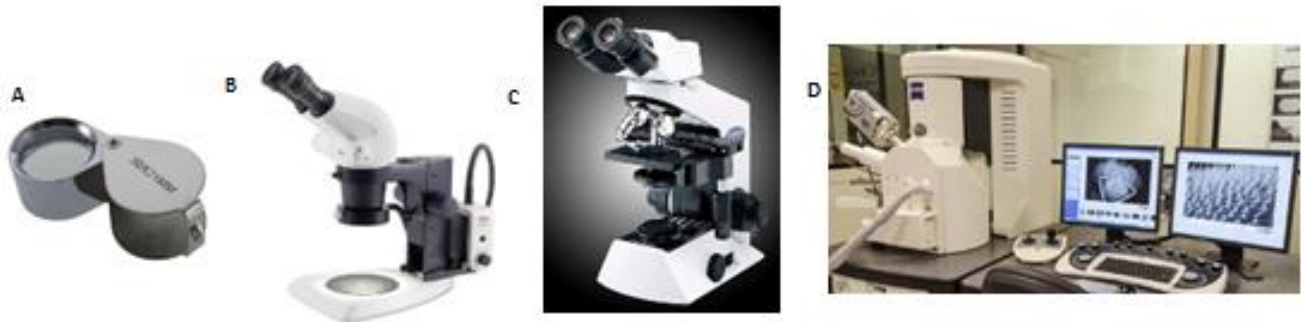
Figura 12 – Equipamentos óticos para o estudo de microfósseis. A) Lupa de bolso; B) Estereomicroscópio (lupa binocular); C) Microscópio de luz transmitida (biológico); D) Microscópio Eletrônico de Varredura (MEV).
