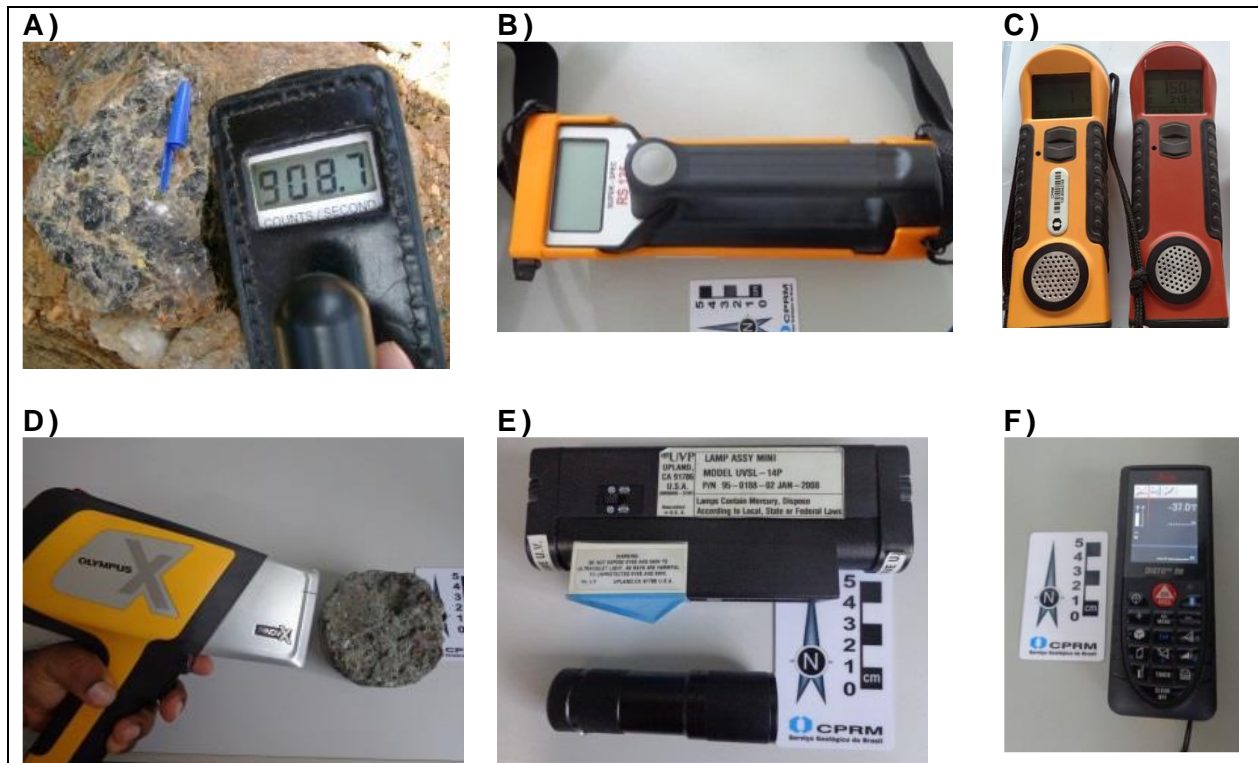
Figura 2 – Equipamentos portáteis passíveis de serem utilizados nas atividades de campo. A) Cintilômetro; B) Gamaespectrômetro; C) Susceptibilímetro (amarelo) e susceptibilímetro/conduktivímetro (vermelho); D) Fluorescência de Raios-X; E) Dois modelos de Mineralight ; F) Mira a laser.
