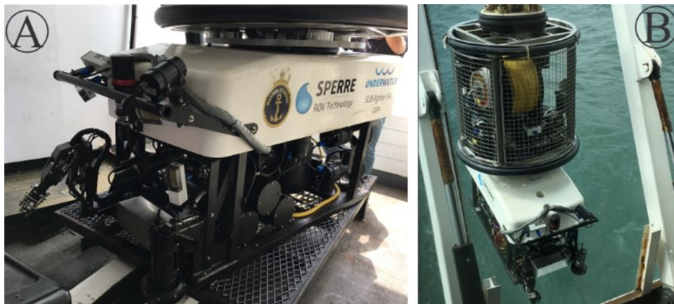
Figura 13 - Veículo operado remotamente (ROV), da marca SPERRE, modelo SUB-fighter 15k (A) em operação no guindaste (B), pertencente ao navio NPqHo Vital de Oliveira.
