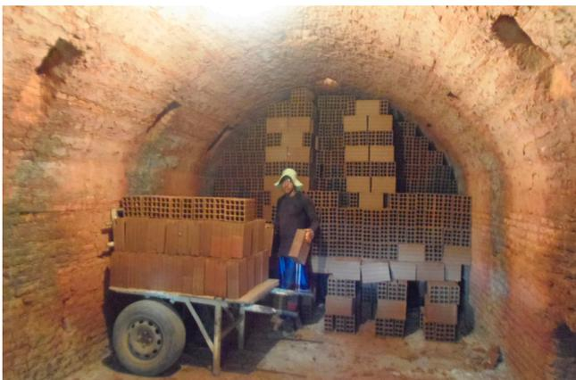
**Figura 5.12** - Forno contínuo para queima do material cerâmico em Santa Rita-PB.
