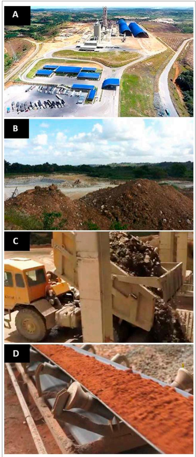
**Figura 5.16** - Etapas de transporte e beneficiamento do calcário e argila para produção de cimento. (A) em Alhandra-PB; (B) Pilha composta de argila que se sobrepõe a camada de calcário; (C) Caminhão basculante descarregando o calcário na unidade de britagem; (D) Transporte da argila já britada por correia transportadora até o galpão de armazenamento.
