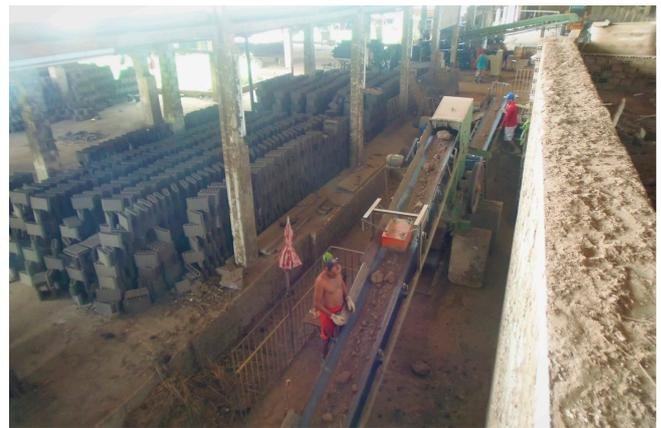
**Figura 5.9** - Sistema produtivo de confecção dos produtos cerâmicos em Santa Rita-PB. Esteira com catação manual para retirada de pedregulho.
