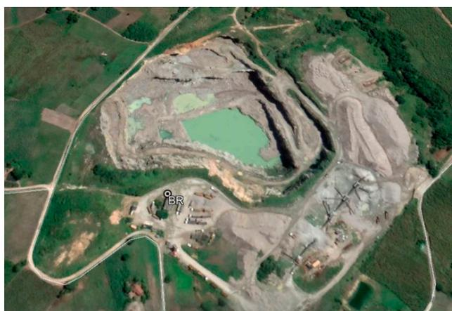
**Figura 5.2** - Pedreira Brita Forte e suas bancadas e pilhas com as classificações do produto final. Rochas graníticas pertencentes a Suíte Intrusiva D. Inês - Pedras de Fogo (Ponto MH-178).
