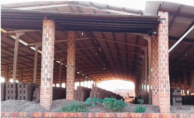
**Figura 5.11** - Galpão de secagem natural dos produtos cerâmicos em Rio Tinto (Ponto MH-309).
