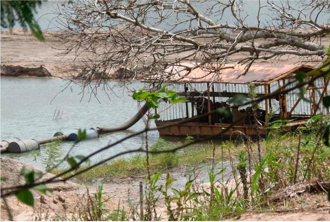
**Figura 5.6** - Processo de lavra por dragagem exibindo barcaça fixa sustentada por tambores flutuantes. Ponto MH-271 areal próximo da PB-016, município Cruz do Espírito Santo-PB.
