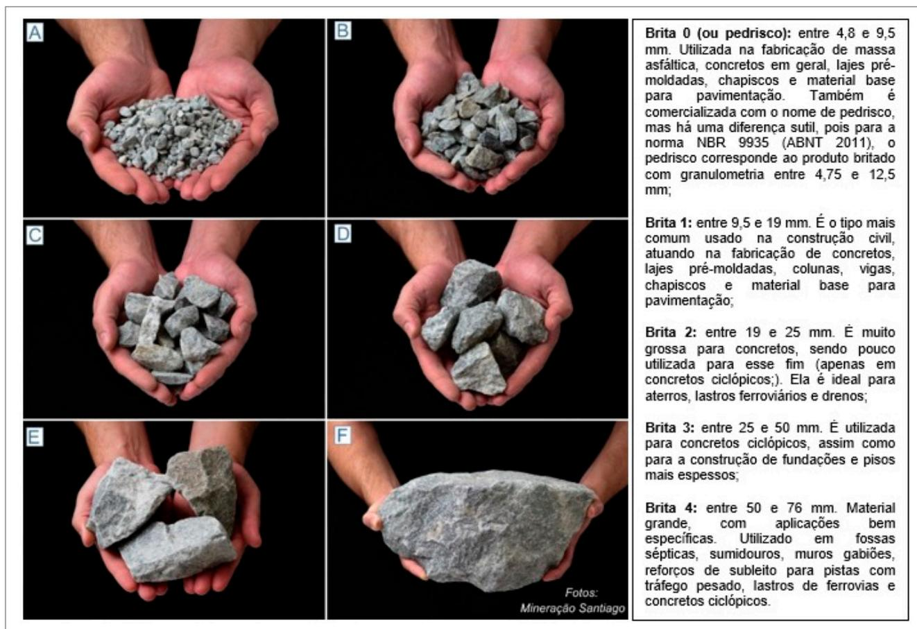
**Figura 4.2** - Tipos de britas resultantes das pedreiras, conforme classificação granulométrica comercializada no mercado.
