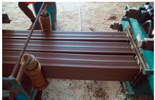
**Figura 5.10** - Extrusora ou “maromba” confeccionando tijolos de 6 furos em Santa Rita-PB.
