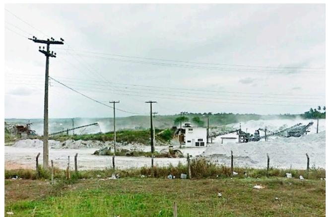
**Figura 5.3** - Sistema de britagem e classificação de granito pertencente a Suíte Intrusiva Ouro Branco, em Mamanguape.
