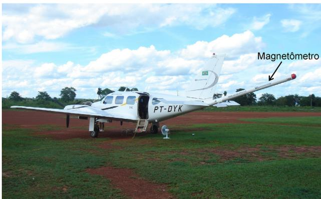
**Fotografia 1** - Avião equipado com magnetômetro do tipo vapor de céσιο montado na cauda da aeronave (tipo *stinger*). Um magnetômetro deste tipo mediu o campo magnético total da Terra a cada 0,1 s.
