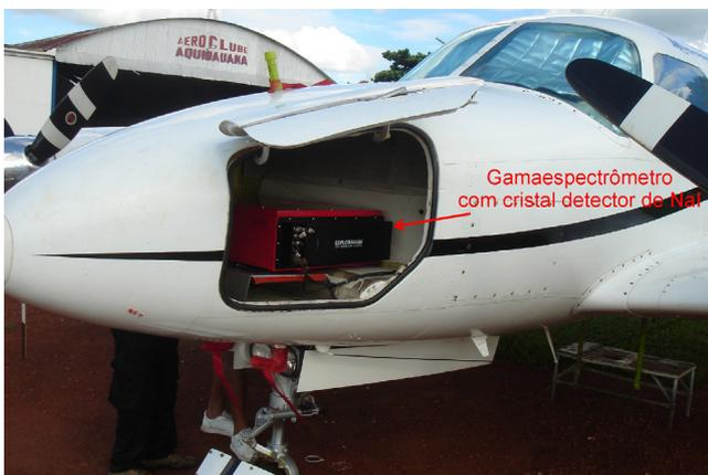
**Fotografia 2** - Avião equipado com gamaespectrômetro com detector de cristal de iodeto de sódio. Um gamaespectrômetro desse tipo mediu a radioatividade natural a cada 1,0 s.
