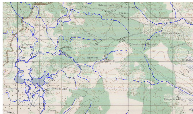
Figura 4.10 – Digitalização da drenagem da folha.
