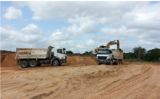
Figura 5.16 - Caçambas basculantes com carroceria dupla, denominadas de “bi trem”, com capacidade para transportar até 30 m 3 de minério. Fonte: Fotografia do Arquivo da SEDEME.
