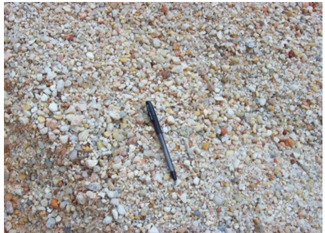
Figura 5.6 - Na foto é possível visualizar o seixo pronto para a comercialização, após passar por processo de beneficiamento bastante simples. Fonte: Fotografia do Arquivo da SEDEME.
