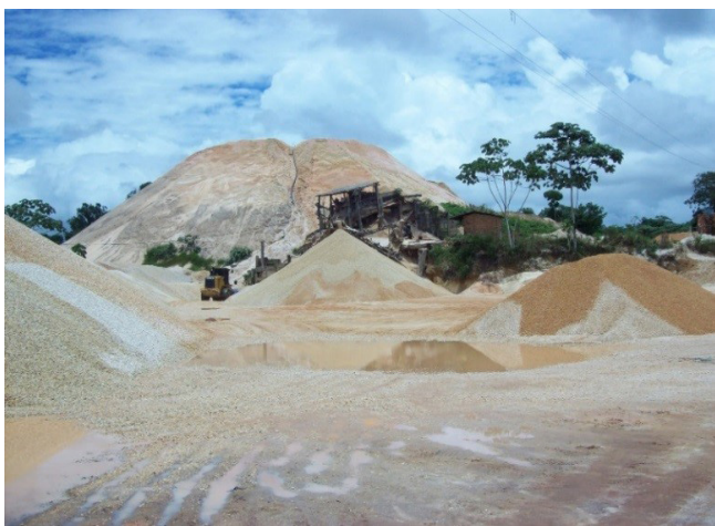
Figura 6.10 - Pilha de rejeito (material arenoso ou arenoargiloso), resultante do processo de beneficiamento do minério (município de Ourém). Fonte: Fotografia do arquivo da SEDEME.
