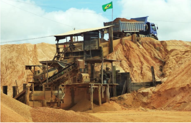
Figura 5.15 - Caçamba basculante com capacidade para 12 m 3 , usada no transporte de minério da frente de lavra até a “planta de beneficiamento”.
