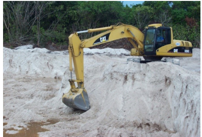
Figura 6.7 - Intercepção do lençol freático, no canto esquerdo inferior da foto (cor marrom), devido ao aprofundamento da lavra de seixo/areia (município de Ourém). Fonte: Fotografia do arquivo da SEDEME.
