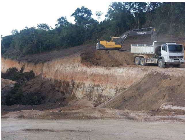
Figura 5.8 - Frente de lavra em uma seixeira no município de Capitão Poço, onde ocorre extração de minério com utilização de escavadeira hidráulica (PC). Nesse local, o corpo de minério chega a atingir 6 metros de espessura, sendo observada também espessa camada de solo orgânico (top soil). Fonte: Fotografia do Arquivo da SEDEME.
