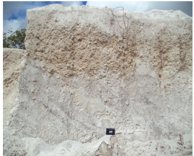
Figura 3.12 - Exposição em frente de lavra de depósitos de areia e seixo esbranquiçados.
