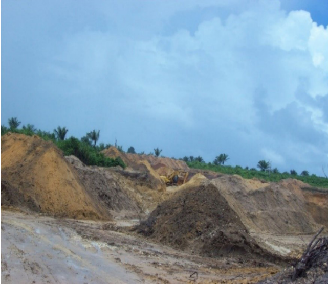
Figura 5.12 - Material resultante da operação do decapeamento, disposto no entorno da área de extração. Fonte: Fotografia do Arquivo da SEDEME.
