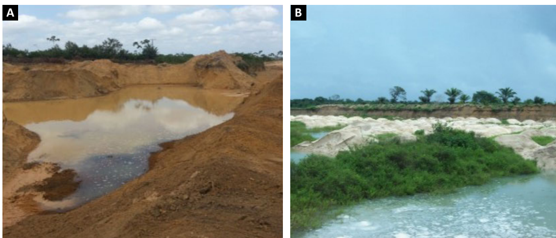
Figura 6.9 - Rejeitos da lavra de seixo/areia dispostos de maneira irregular no entorno e no interior das cavas (com interceptação do lençol freático), sem nenhum critério técnico, dificultando (e encarecendo) sobremaneira a recuperação ambiental. Fonte: Fotografias do arquivo da SEDEME.
