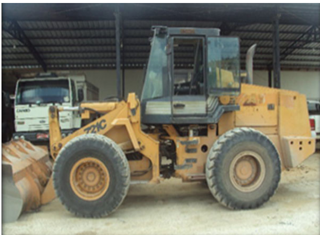
Figura 5.20 - Pá carregadeira, utilizada na operação de desmatamento, decapeamento e terraplenagem.
