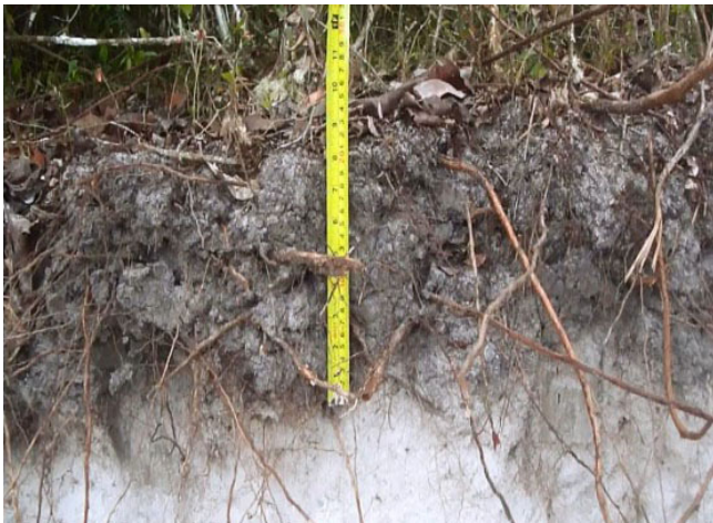
Figura 5.5 - Camada de solo arenoso com matéria orgânica ( top soil ), localmente areno-argiloso, coloração cinza escuro, com espessura média de 0,20 m. Fonte: Fotografia do Arquivo da SEDEME.
