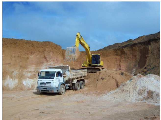
Figura 5.9 - Antiga área de extração de seixo, localizada próximo à margem direita do rio Guamá, município de Ourém. Extração de minério com o emprego de PC, que também efetua o carregamento em caçamba basculante. Fonte: Fotografia IAECY Consultoria.
