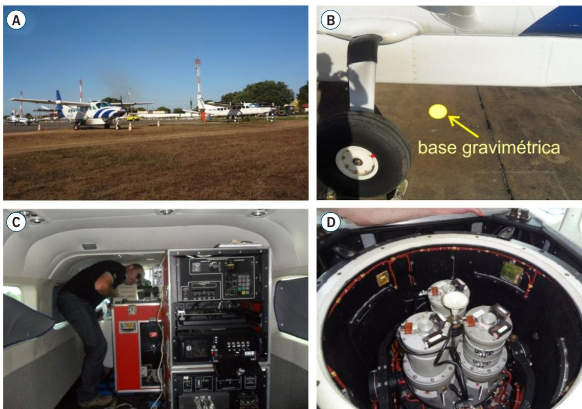
**Figura 10** - A) Aviões modelo Cessna empregados no aerolevanteamento, estacionados na base de operação do aeroporto de Marabá (PA). B) Avião sobre base gravimétrica. C) Equipamentos de aquisição, processamento e navegação. D) Aerogravímetro GSS3 Graviton-M da Microsurvey Ltda. empregado no aerolevanteamento.
