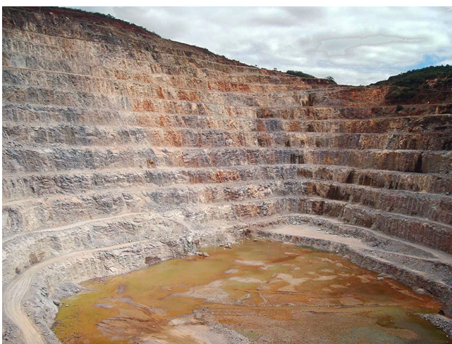
Figura 5.1 - Panorama da frente de lavra da mina Pedra Preta (82ms,tl) mostrando o desnível da cava. Altura da bancada aproximada de 5 m.
