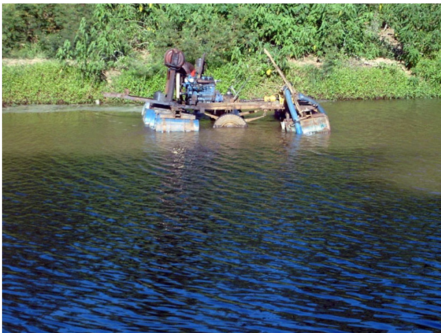
Figura 5.6 - Draga no leito do rio Brumado utilizada na sucção de areia (38ar).
