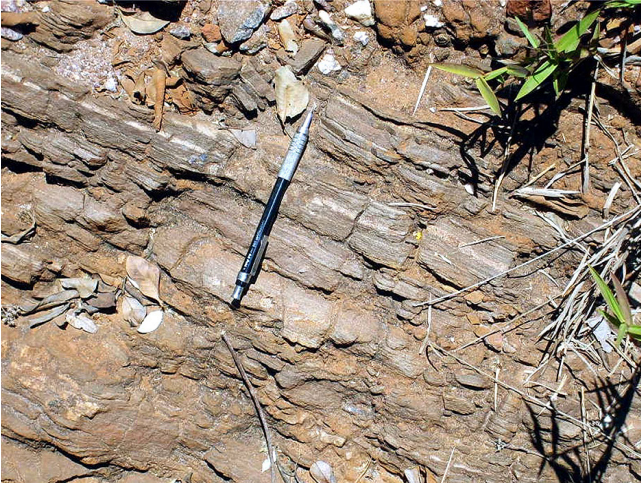
Figura 3.42 - Afloramento de formação ferrífera fácies óxido e silicática, com níveis quartzosos finos, em exposições rasteiras à margem da estrada interna na mina da Magnesita.
