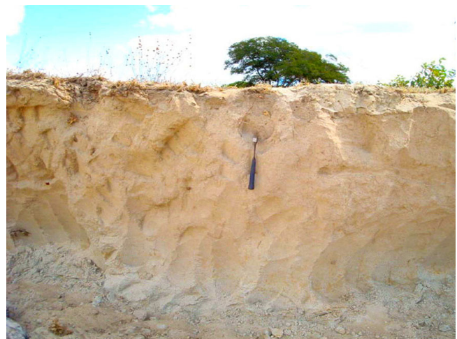
Figura 5.5 - Frente de lavra da areia tipo residual, à margem da rodovia Piripá-Condeúba (215ar).
