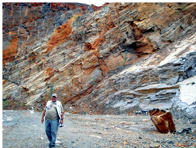
Figura 5.11 - Frente de lavra de calcário dolomítico laminado da fazenda Barreiro (29ca); mina paralisada da Correta Ltda.
