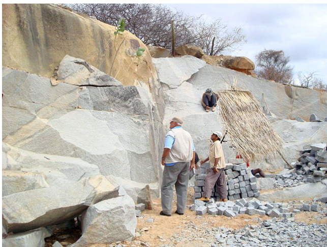
Figura 5.8 - Aspecto da frente de lavra, com estoque de paralelepípedo e de pedra de alicerce; pedreira Gameleira I (9pr-gr).
