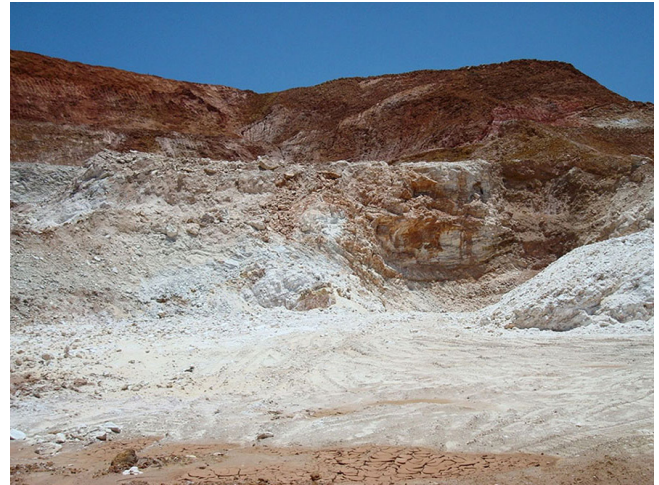
Figura 5.2 - Frente de lavra de talco da mina Cabeceiras (98,ms,tl). Altura da bancada de aproximadamente 5 m.
