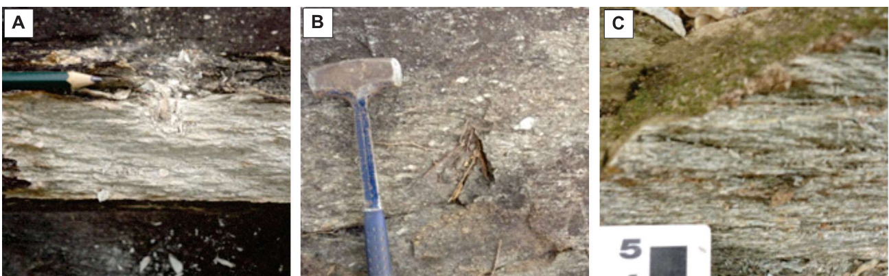
Figura 3.9 - (A) Quartzito branco, fino, bem selecionado, em camadas delgadas tabulares; (B) Grânulo quartzito moderadamente selecionado a mal selecionado em camada espessa; (C) Filito Cinza com intercalações de lâminas milimétricas de sericita xisto e quartzito fino.
