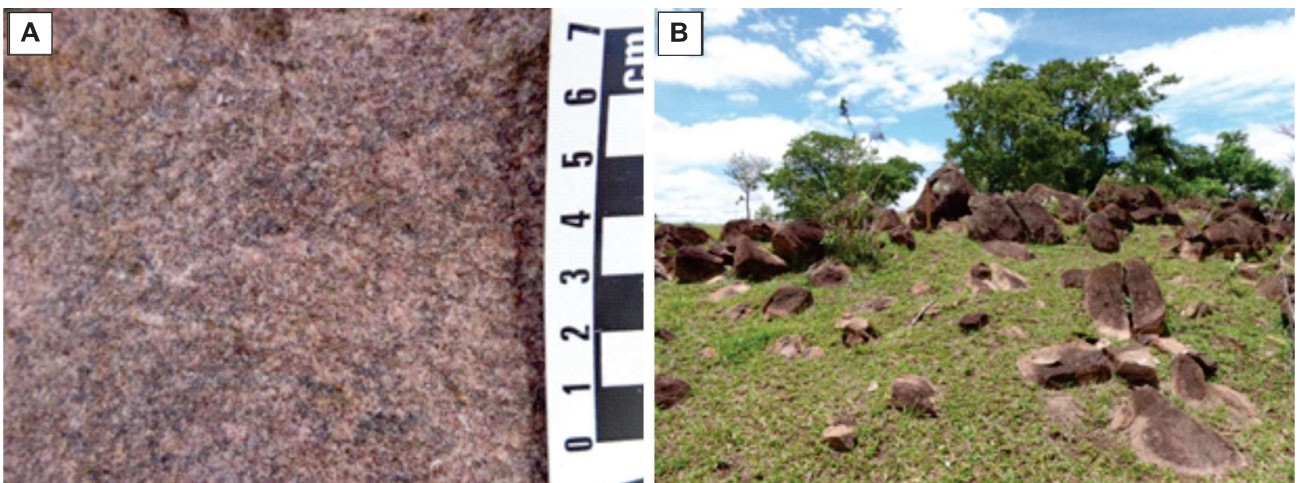
Figura 3.5 - (A) Granito róseo equigranular médio xenomórfico, levemente foliado e (B) Blocos e matacões de granito pertencentes ao Corpo Baía das Graças.
