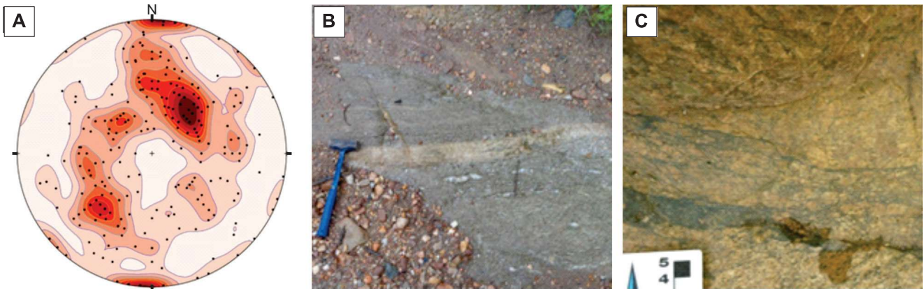
Figura 4.2 - (A) Diagrama estereográfico equal-área hemisfério inferior demonstrando os pólos (N=312) e contornos de pólos da foliação principal ( S_n ) em gnaisses e metassedimentos pertencentes ao embasamento. (B) Hornblenda biotita gnaisse com textura milonítica (ortogneisse Morraria). (C) Pseudotaquilito em biotita ortogneisse Caracol.
