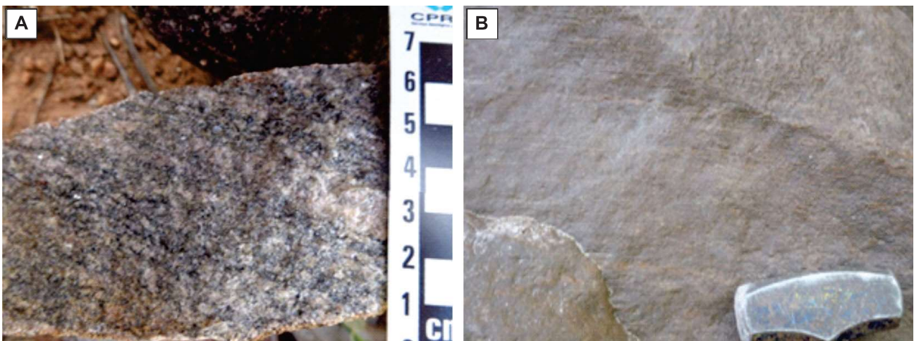
Figura 3.4 - (A) Biotita-hornblenda gnaiss cinza equigranular médio e (B) epidoto-biotita gnaiss com textura milonítica.
