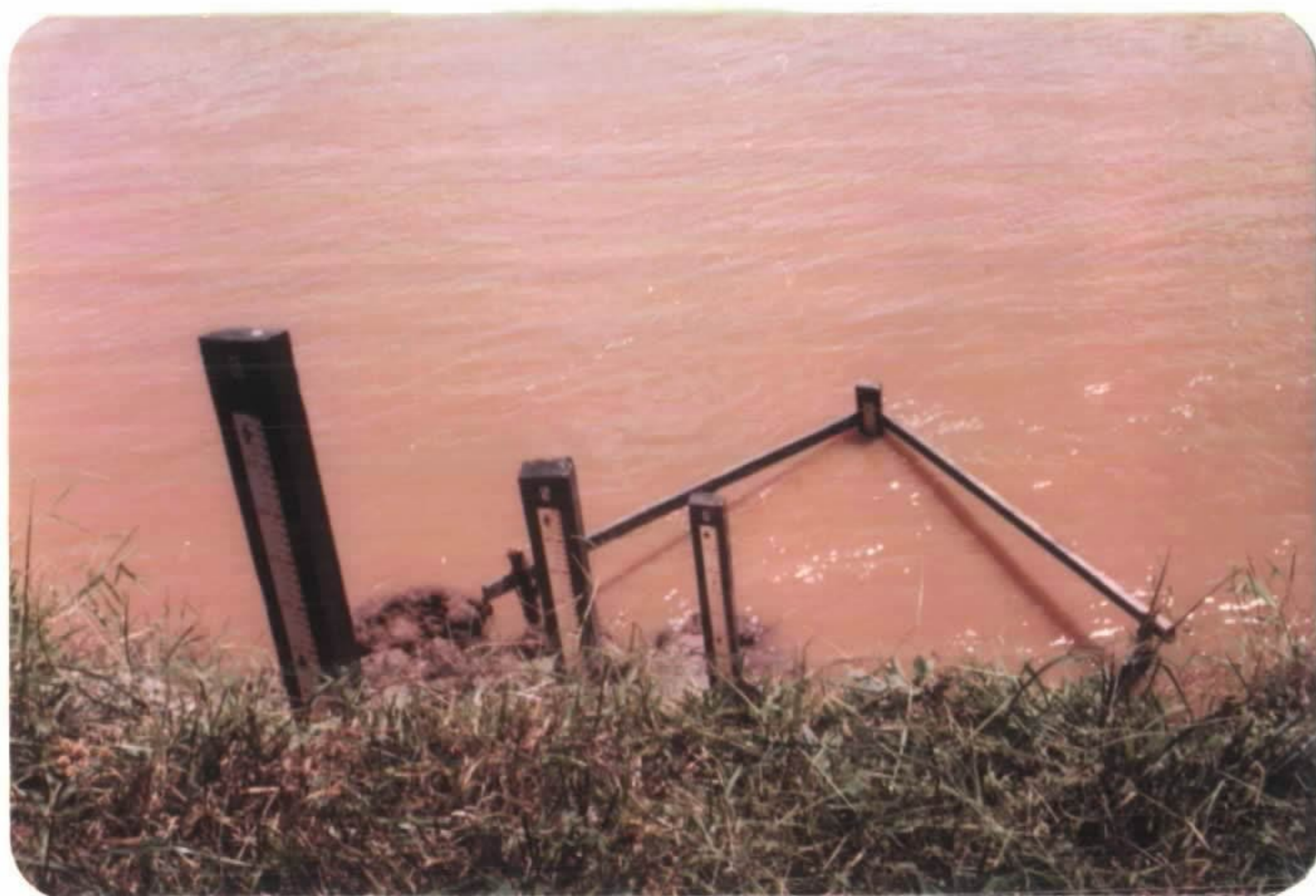
Foto 6 - Régua fluviométrica em quatro estágios, instalada no rio Jequitinhonha, em frente à turfeira Fazenda Monte Alegre.
