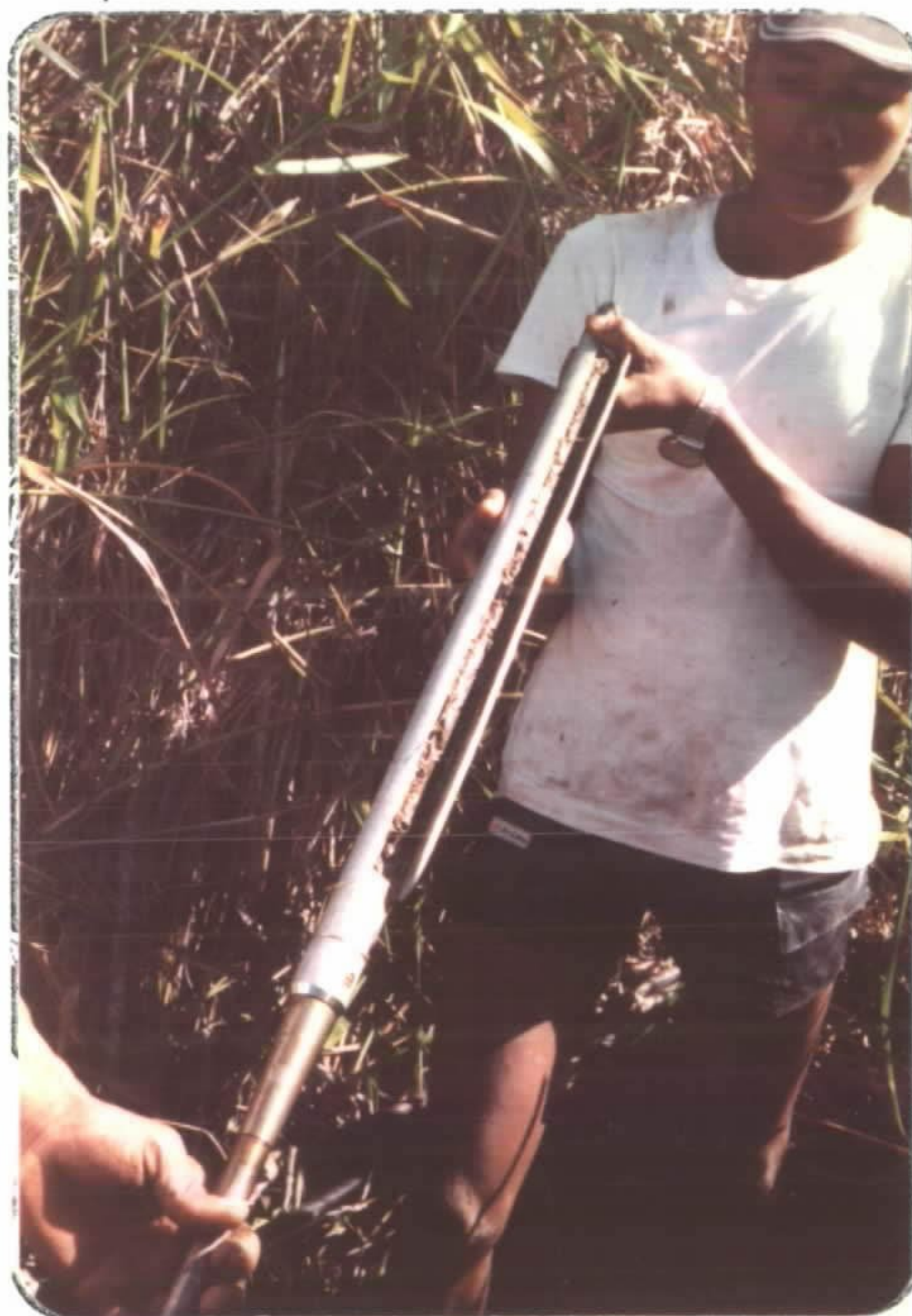
Foto 2 - Detalhe do amostrador HILLER em posição aberta. Vegetação do tipo capim pau.
