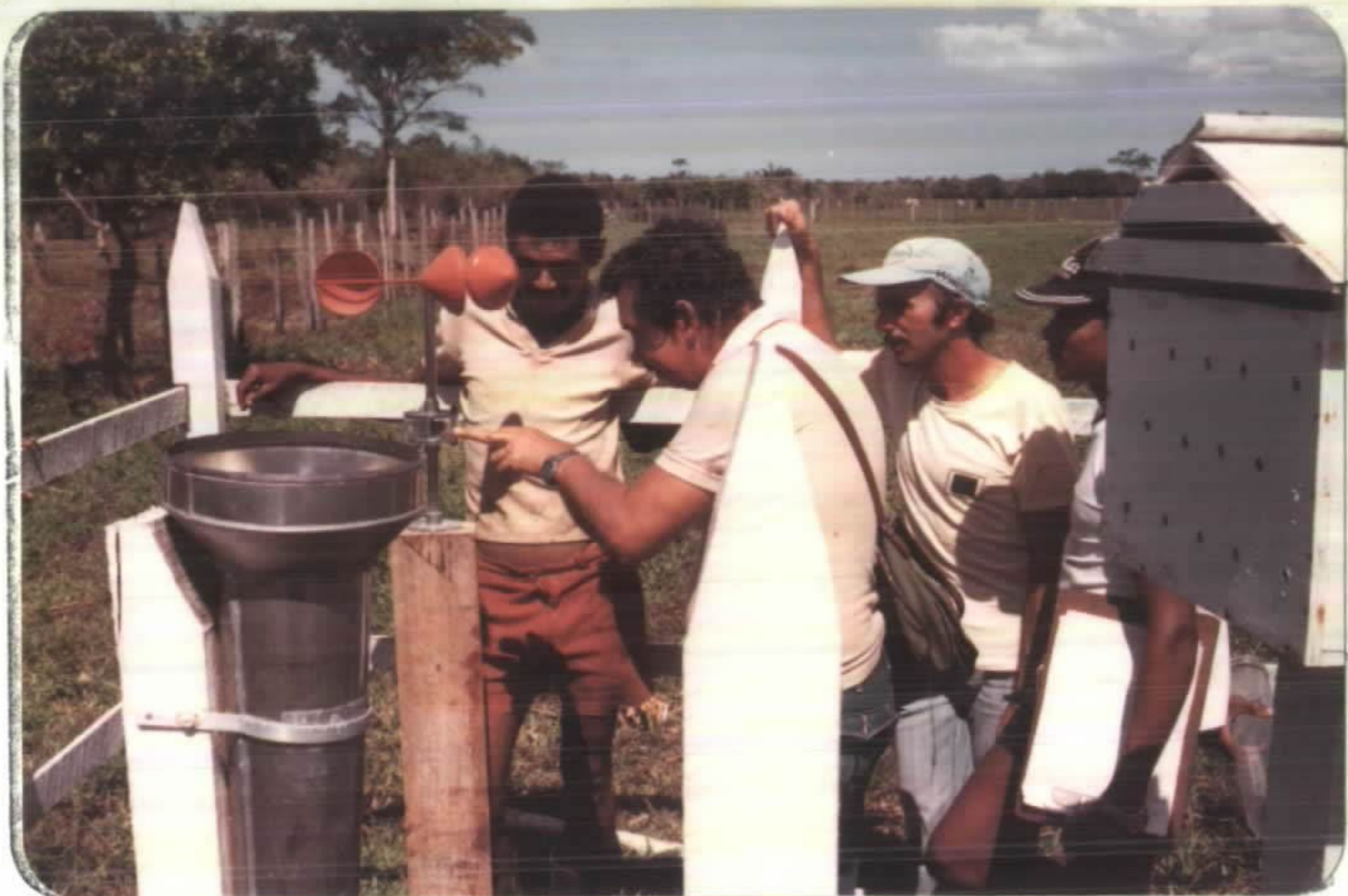
Foto 5 - Estação meteorológica da Fazenda Monte Alegre, observando-se à esquerda anemôtro e pluviômetro. À direita gabinete projetor de termômetro e evaporímetro.
