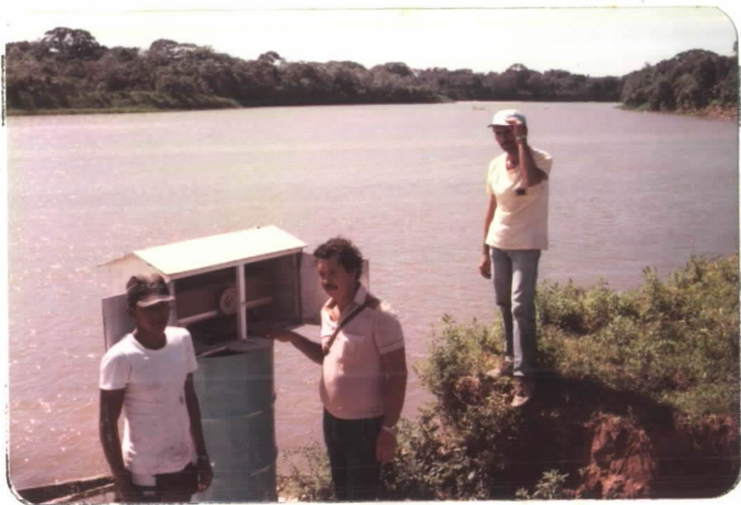
Foto 8 - Linígrafo instalado no rio Jequitinhonha, em frente à turfeira Fazenda Monte Alegre.
