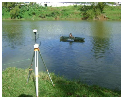
Fig 11. Medição de Vazão com equipamento M9. (Sistema ADCP – Acoustic Doppler Current Profile).
