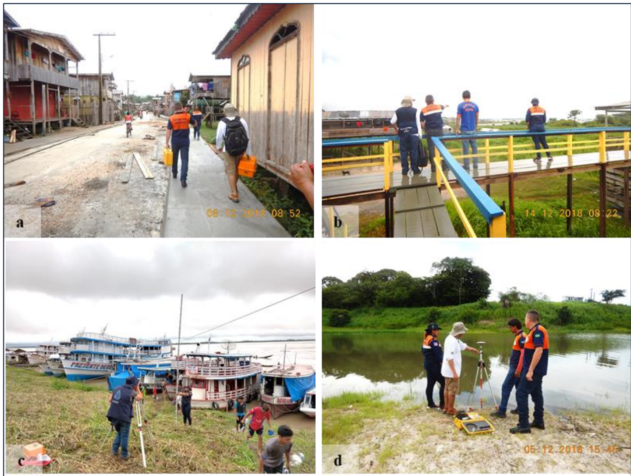
Figura 4. Metodologia de campo: Contato com as defesas civis locais (a) em Anamá-AM e (b) em Coari-AM e obtenção das cotas ortométricas com GPS geodésico (c) e (d) em Manacapuru-AM.
