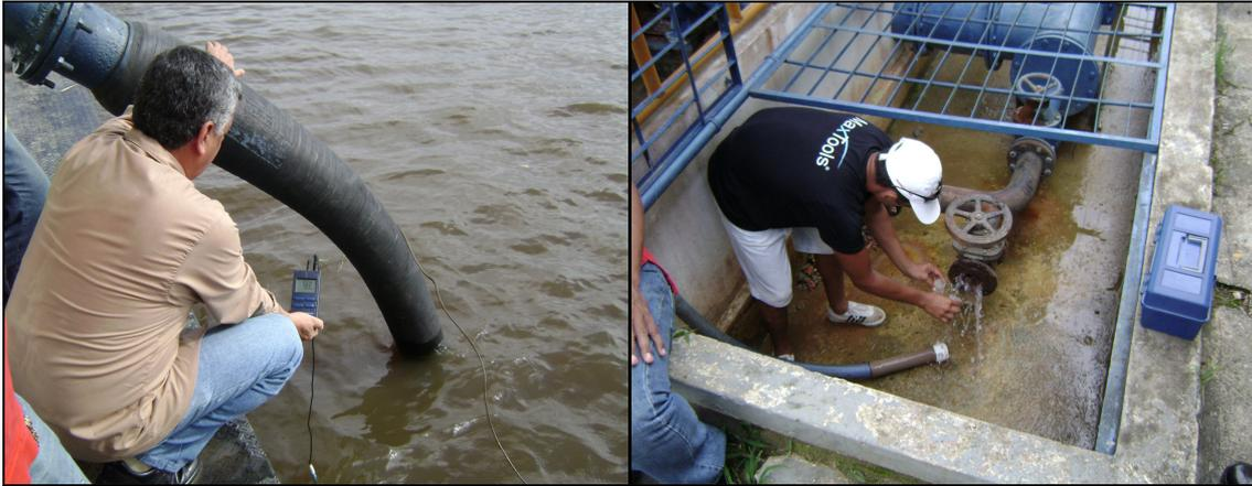
**Figura 7.2.2.3** – À esquerda, determinação *in situ* do pH do rio Javari no local de captação de águas brutas para a ETA; à direita, coleta de amostra de água tratada na saída da ETA.
