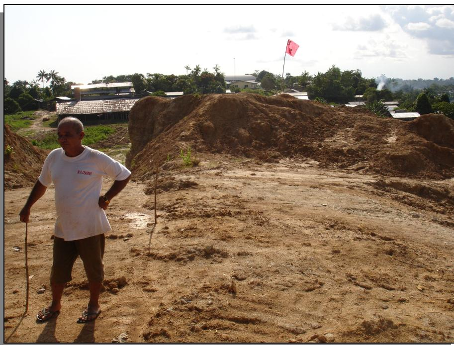
**Foto 7.1.5.2** – Jazida, com aproximadamente 2,5 hectares de dimensão, de onde é extraída a argila utilizada como matéria-prima na olaria municipal de Atalaia do Norte.
