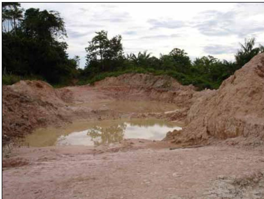
**Foto 7.9.5.2** – Jazida de onde é extraída a argila utilizada como matéria-prima na olaria lavé
