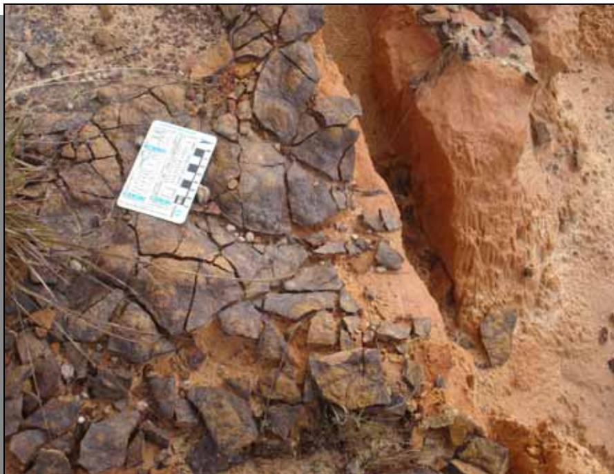
**Foto 7.4.5.6** - Horizonte endurecido, enriquecido em ferro, observado no areal situado próximo ao aeroporto
