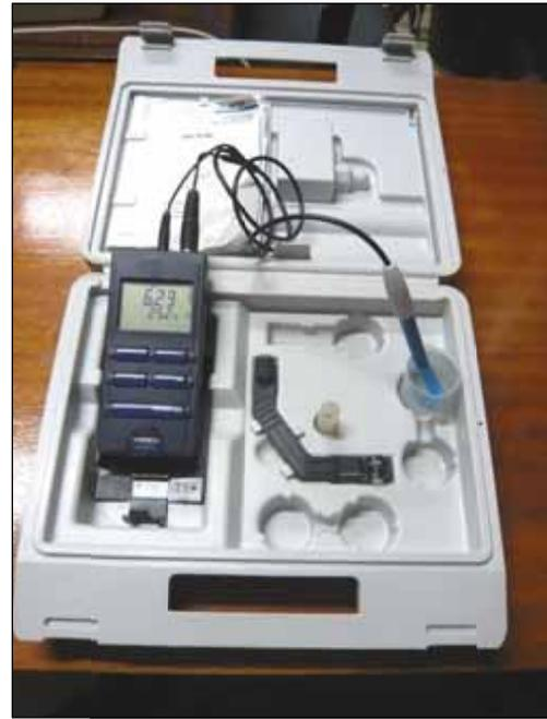
**Figura 5.1** – Aparelhos digitais de marca WTW utilizados nos trabalhos de campo para determinação de condutividade elétrica e pH das águas de abastecimento: à esquerda, o condutivímetro e, à direita, o pHmetro.
