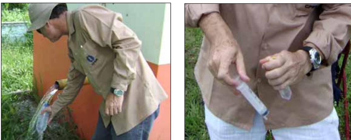
**Figura 5.3** – À esquerda, coleta de amostra de água de poço, na alíquota de 600ml, para ser enviada ao laboratório do INPA; à direita, coleta e filtragem de amostra de água, na alíquota de 50ml, para se enviada ao LAMIN.
