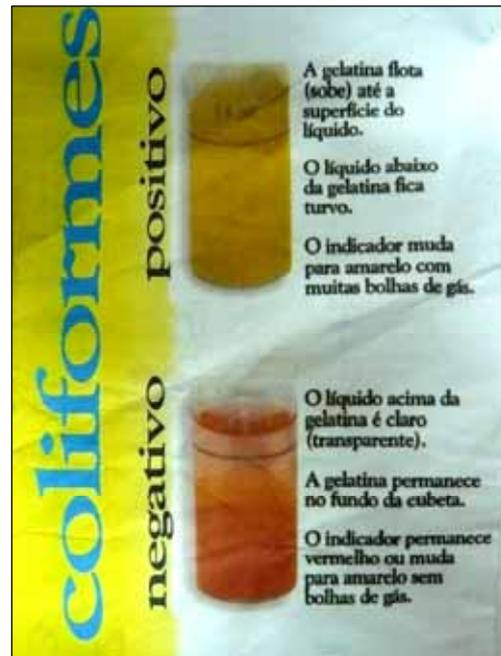
**Figura 5.2** – À esquerda, cubeta do teste de coliformes La Motte, contendo a pastilha de reagente; à direita, esquema contido no kit do teste, mostrando a coloração e as diferentes características da gelatina, indicativas dos resultados positivo e negativo.
