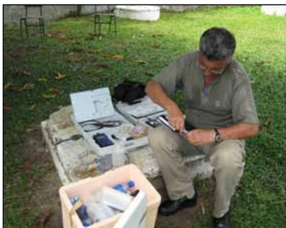
**Foto 7.4.2.4** – Coleta de amostra de água tratada na ETA e medição *in loco* dos valores de condutividade elétrica e pH.
