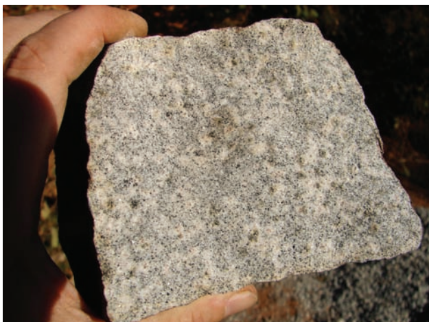
Figura 3.40 – Granulação fina em microgranito do Corpo Conselheiro Paulino. Os pontos escuros são halos em torno de allanita. Amostra de afloramento na área urbana de Nova Friburgo, a leste do Córrego da Bengala, com cerca de 12 cm
