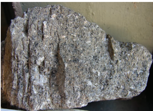
Figura 3.41 – Microdiorito microporfirítico do Corpo Conselheiro Paulino com fenocristais tabulares e milimétricos de plagioclásio. Amostra com cerca de 10 cm obtida em afloramento em corte de rua do bairro de Conselheiro Paulino, em Nova Friburgo
