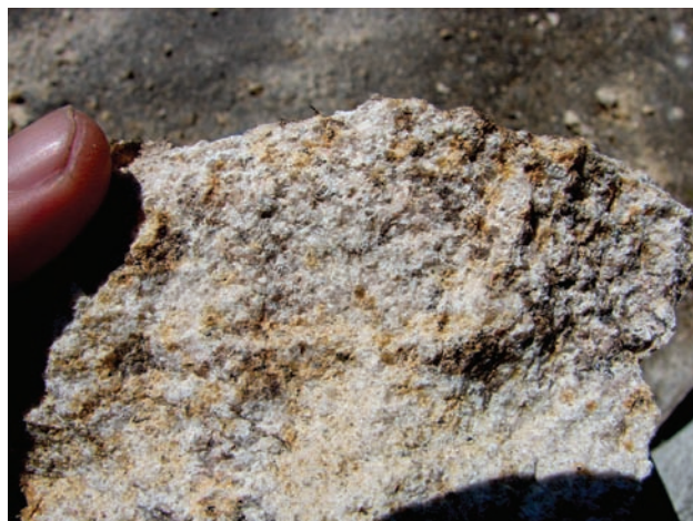
Figura 3.26 – Aspecto macroscópico de granito do Corpo Teresópolis, com trama quartzo-feldspática hololeucocrática de grão médio. Amostra parcialmente alterada de afloramento em corte da BR-116
