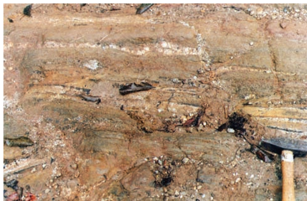
Figura 3.3 - afloramento semi-alterado de kinzigito do Grupo São Fidélis, destacando vênulas quartzo-feldspáticas ao longo da foliação. Leito da antiga Estrada de Ferro Cantagalo, na margem esquerda do Rio Macacu
