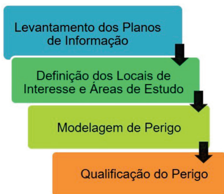
FIGURA 1 - Fluxograma para mapeamento de perigo. Fonte: Elaborado pelos autores.
