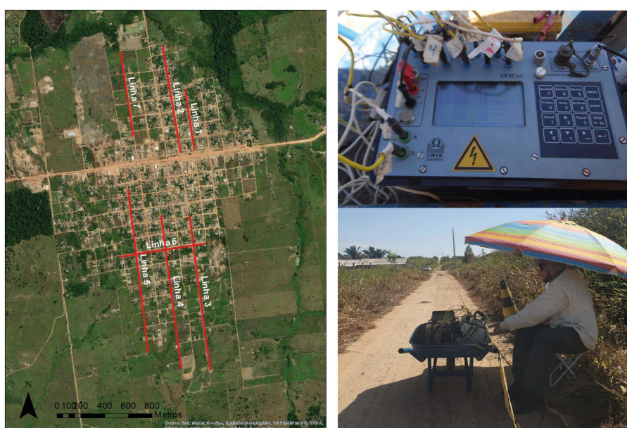
Figura 5. Mapa de distribuição espacial dos caminhamentos elétricos realizados. Equipamento (Syscal Pro) utilizado para aquisição dos dados geofísicos de eletrorresistividade. Técnico do Serviço Geológico do Brasil operando na linha de caminhada elétrica.
