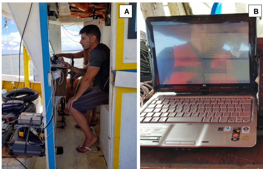
Figura 29: A) Navegação e aquisição de dados batimétricos; B) Momento da aquisição batimétrica, onde notebook mostra parâmetros dos dados em tempo real.
