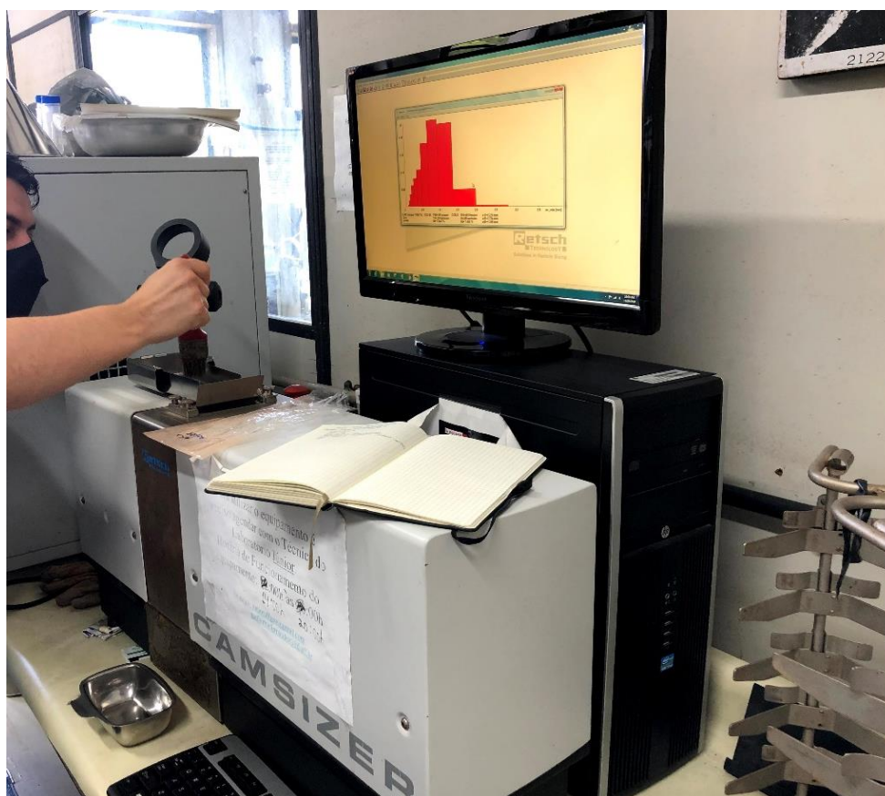
Figura 40: Análise granulométrica através do equipamento CAMSIZER do Laboratório de Sedimentologia da UFF.
