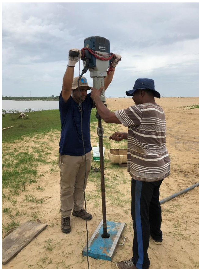
Figura 35: Equipamento RKS em operação de perfuração.
