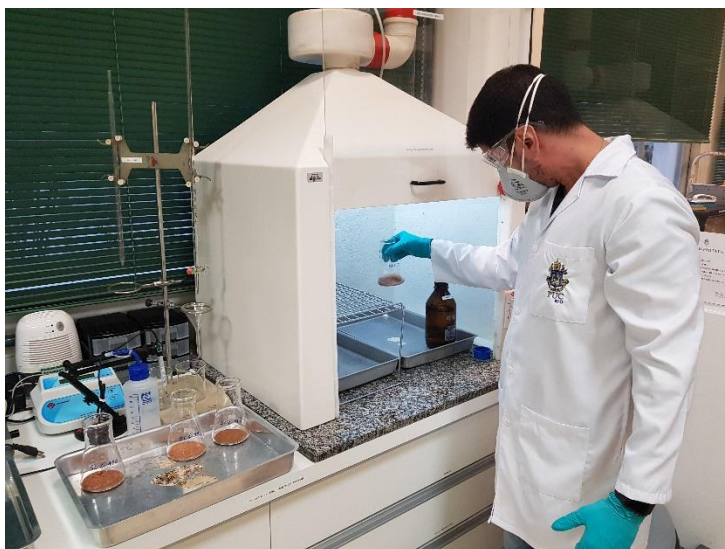
Figura 39: Uso de ácido clorídrico (HCl) para queima de carbonatos em capela de exaustão de gases do laboratório de Geografia Física da PUC-Rio ( \text{CaCO}_3 ).
