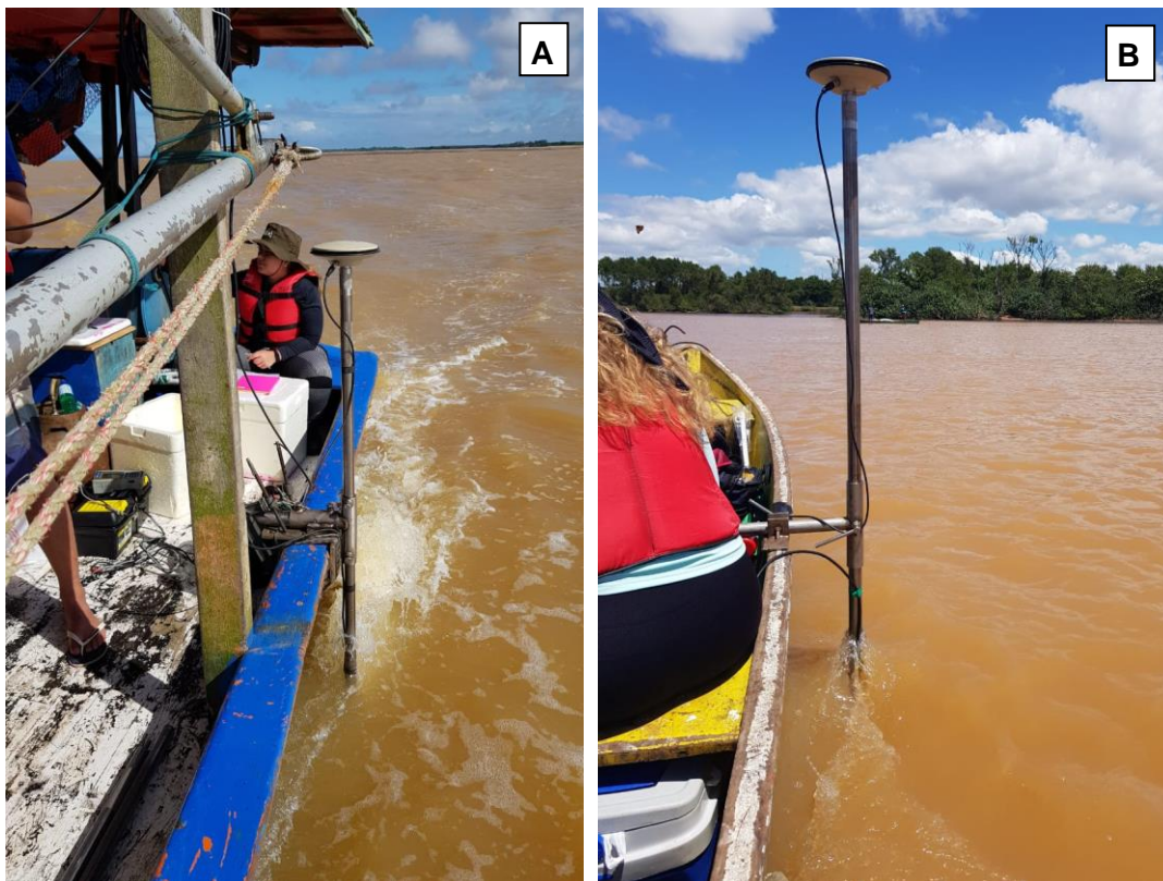
Figura 28: A) Haste com DGPS acoplado ao ecobatímetro, instalado para aquisições na região marinha. B) Haste com DGPS acoplado ao ecobatímetro, instalado em embarcação pequena para aquisições na laguna.
