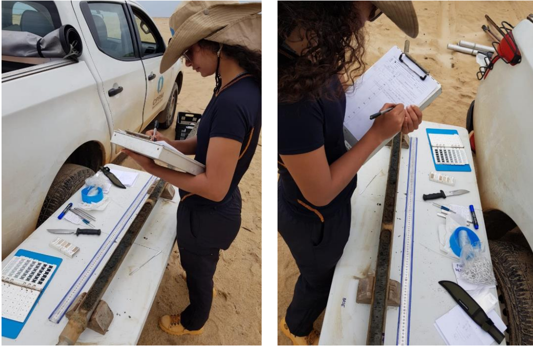
Figura 37: Análise e descrição dos testemunhos da sondagem RKS, assim que é recuperada do terreno.
