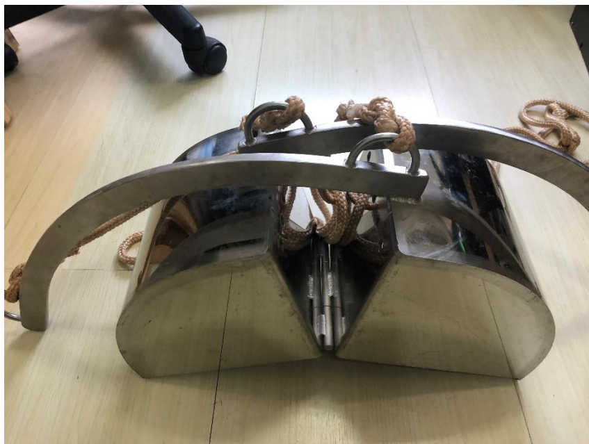
Figura 30: Amostrador do tipo Van Veen , utilizado para coleta de sedimentos.
