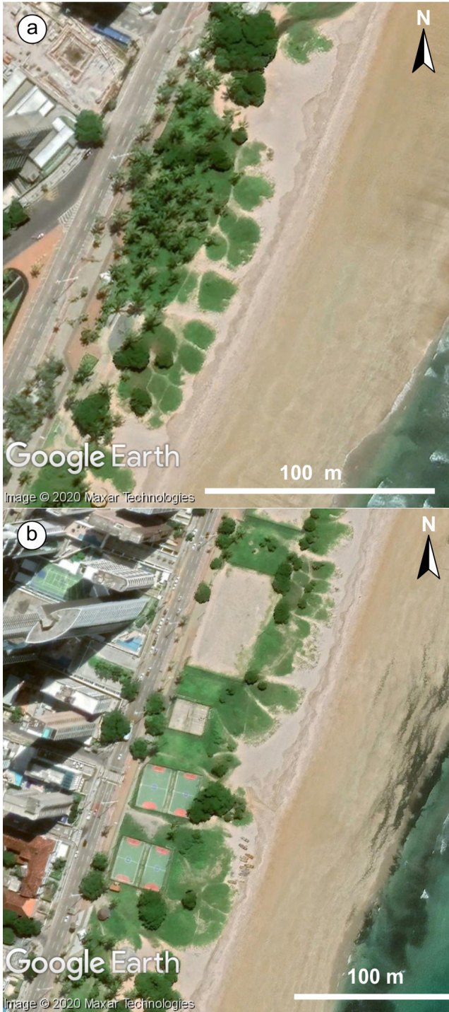
Figura 6 - Dunas costeiras nas praias de Boa Viagem (a) e do Pina (b), em Recife. Observa-se que a faixa de dunas do Pina, embora mais larga do que a de Boa Viagem, está sendo mais ocupada por equipamentos públicos de lazer, o que pode afetar, futuramente, o processo erosivo experimentado por grande parte da linha de costa da Região Metropolitana de Recife. (Fonte: Google Earth).
