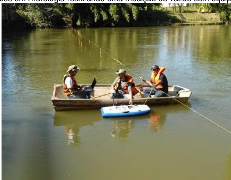
Figura 4: Técnicos em Hidrologia realizando uma medição de vazão com equipamento acústico
