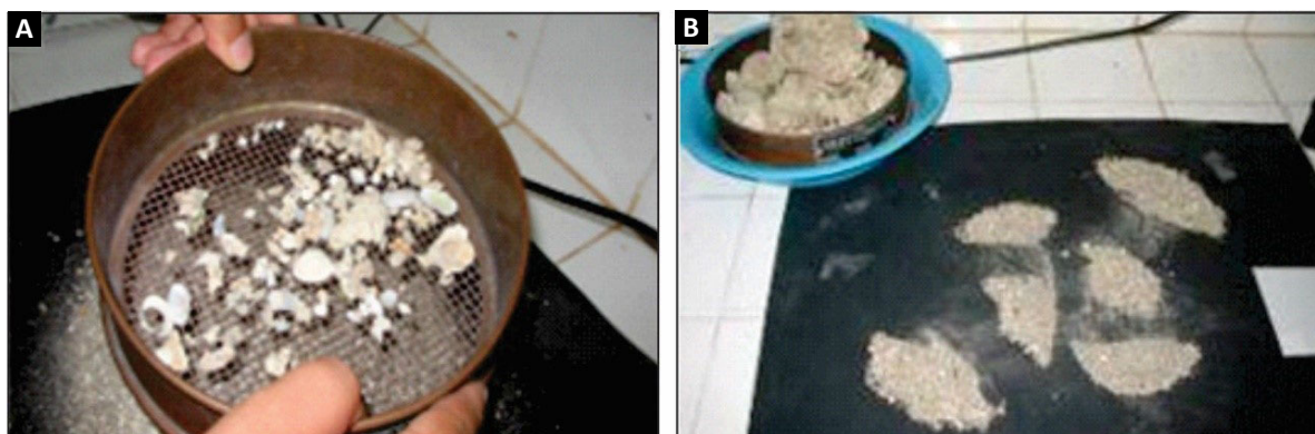
Figura 25 - Preparação prévia das amostras: (A) separação na peneira de 4 mm e (B) quarteamento.
