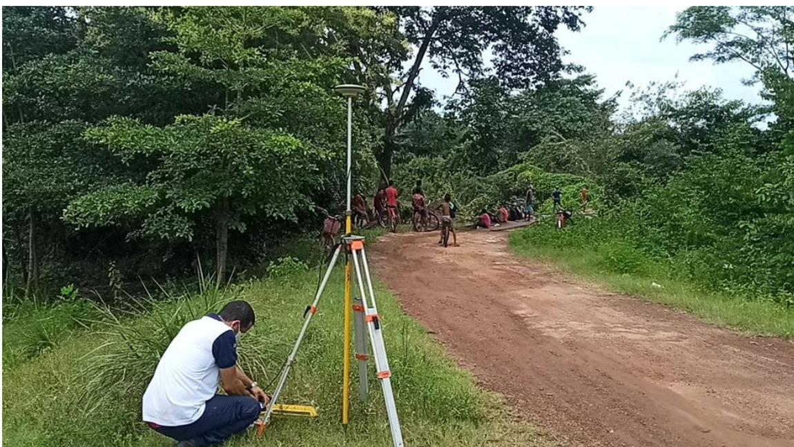
Figura 10. Levantamento da cota de inundação na localidade Ponte do Sardinha em Cantanhede/MA.
