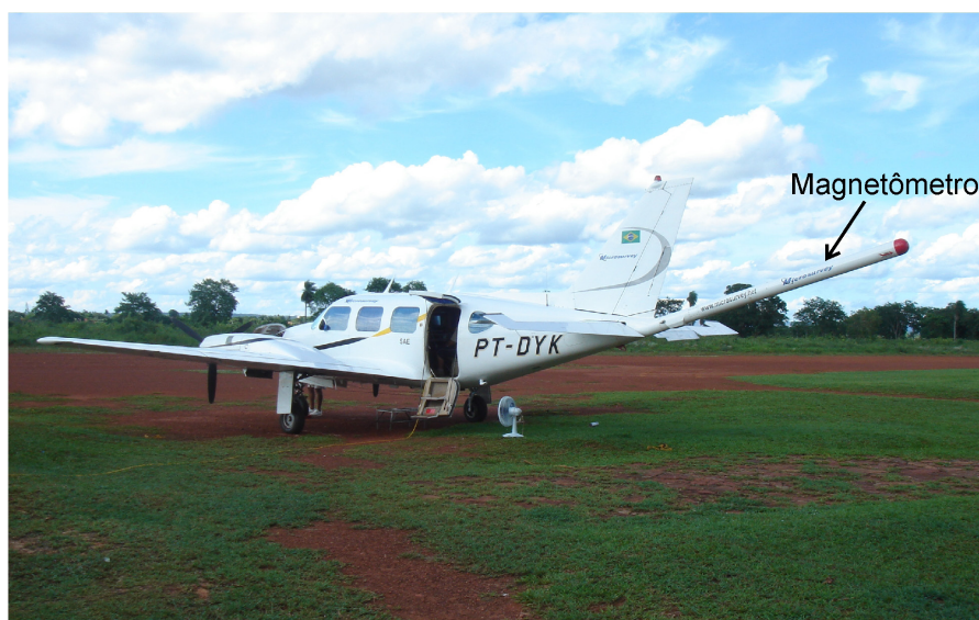
Fotografia 1 - Avião equipado com magnetômetro do tipo vapor de cézio montado na cauda da aeronave (tipo stinger). Este magnetômetro mede o campo magnético total a cada 0,1 s.
