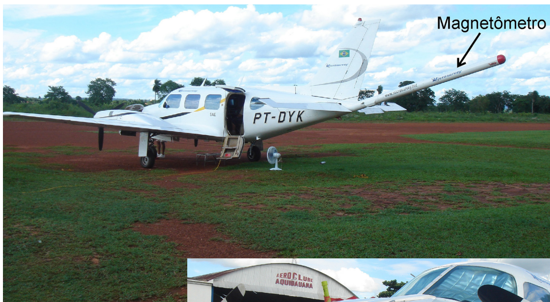
Fotografia 1 - Avião equipado com magnetômetro do tipo vapor de cézio montado na cauda da aeronave (tipo stinger ). Este magnetômetro mede o campo magnético total a cada 0,1 s.
