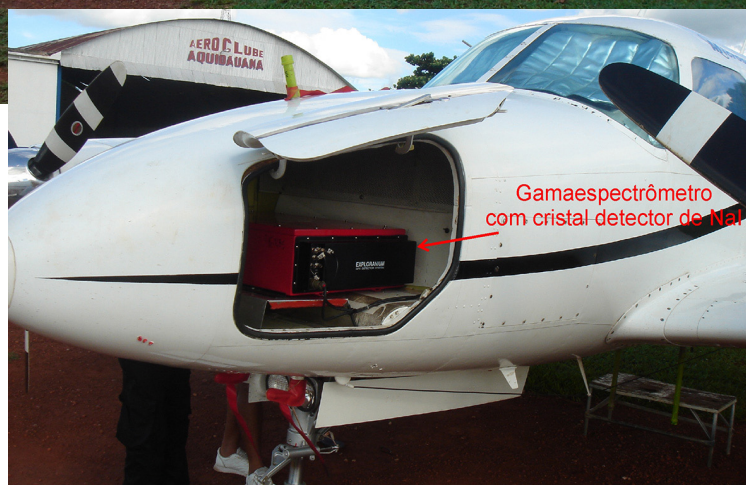
Fotografia 2 - Avião equipado com gamaespectrômetro com detector de cristal de iodeto de sódio. Este gamaespectrômetro mede dados de radioatividade natural a cada 1,0 s.
