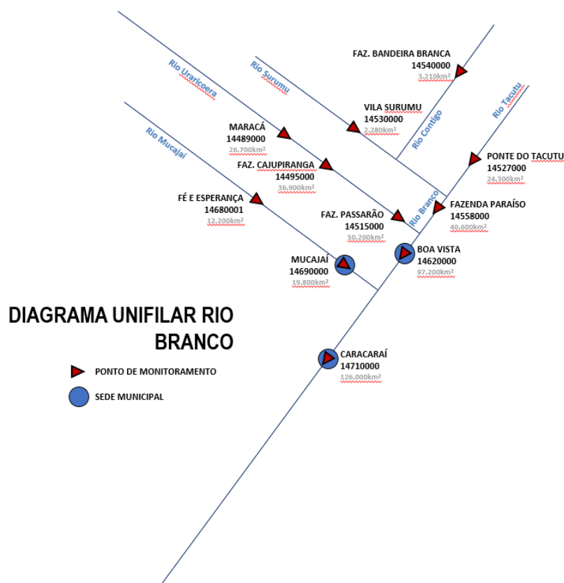
Figura 2: Diagrama unifilar da bacia do rio Branco, com destaque para as estações de monitoramento, sedes municipais, os principais afluentes do rio, áreas de drenagem e distância entre as estações.
