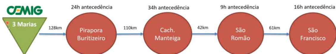
Figura 11: Diagrama unifilar da bacia com os tempos de propagação da onda de cheia ao longo do trecho monitorado do rio São Francisco.
