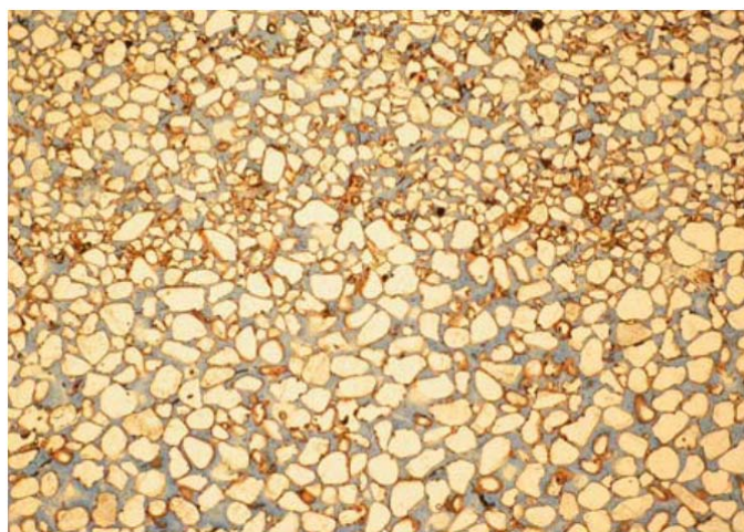
Figura 1.13 - Fotomicrografia mostrando os quartzoarenitos da Formação Posse. Aspecto da bimodalidade dos grãos de quartzo, do cimento de óxido/hidróxido de ferro e da porosidade intergranular.
