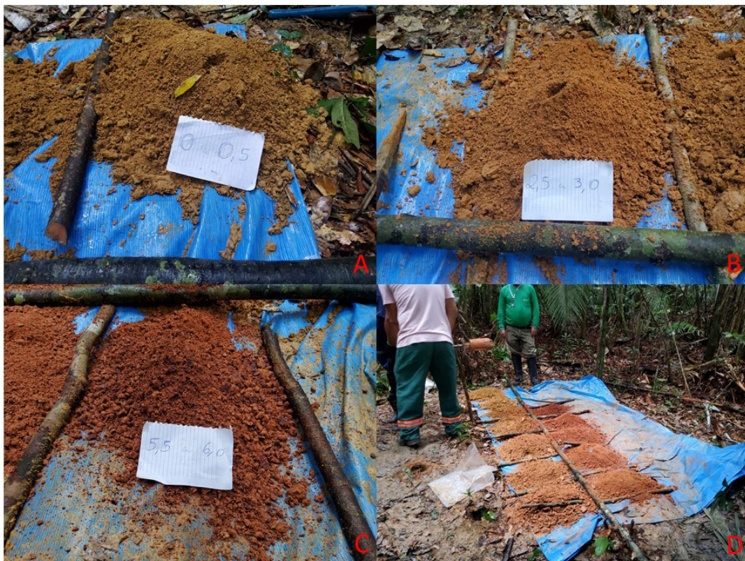
Figura 11 - Furo SSU-02. A) Solo siltoso do intervalo inicial mostra cores similares com o início do furo anterior. B) Solo silto-argilo-arenoso, já avermelhando, do intervalo entre 2,5 e 3,0m. C) Solo vermelho, com nódulos de laterita, do intervalo entre 5,5 e 5,8m. D) Todas as amostras dispostas no final da perfuração.
