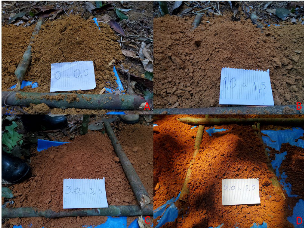
Figura 10 - Furo SSU-01. A) Intervalo de 0,0 a 0,5m, onde se observa solo silto-areno-argiloso amarelado. B) Solo amarelado silto-argiloso, já gradando para avermelhado, entre 1,0 e 1,5m. C) Solo avermelhado, silto-areno-argiloso, no intervalo entre 3,0 e 3,5m. D) Solo vermelho com nódulos de laterita, do intervalo final do furo (5,0 – 5,6m).
