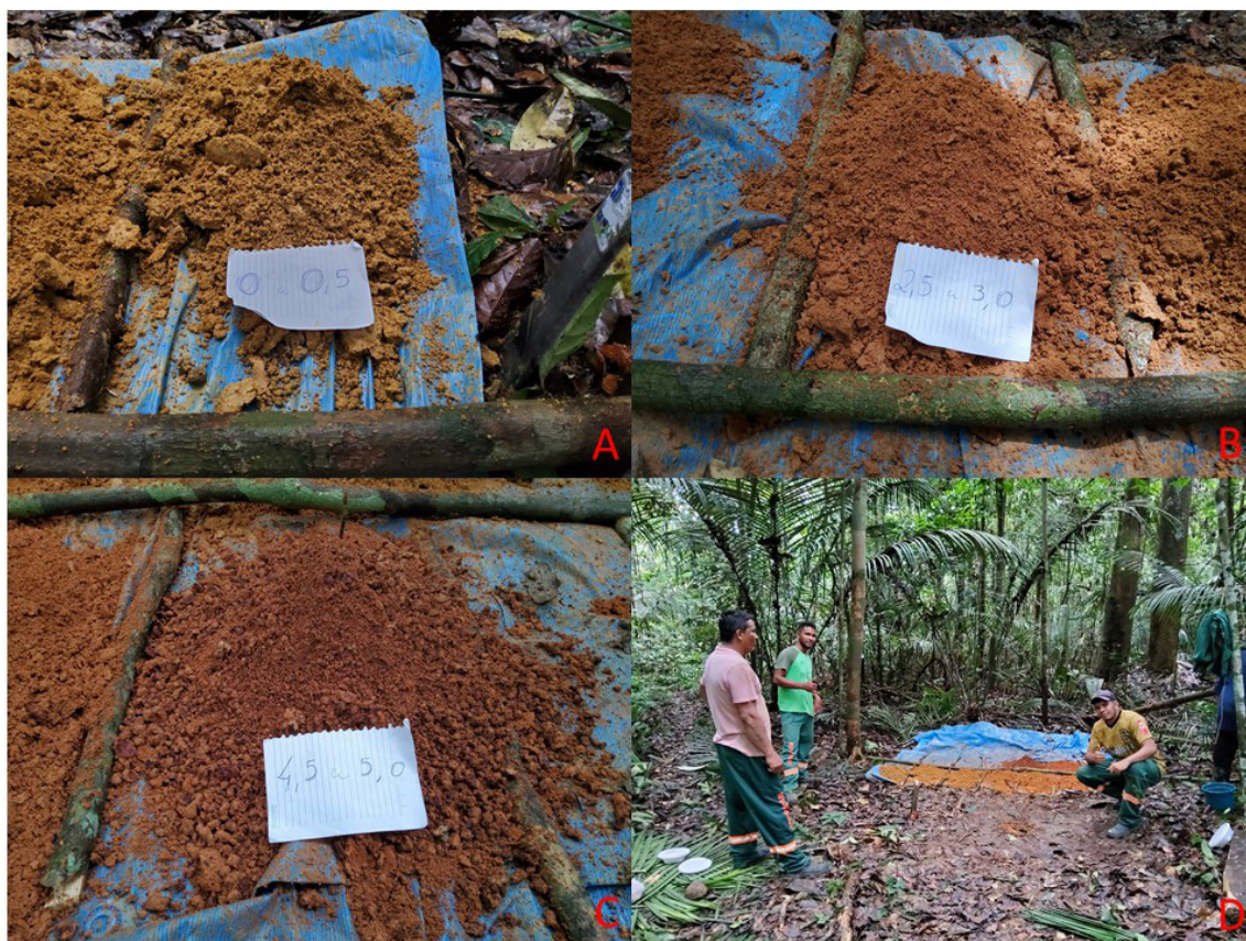
Figura 12 - Furo SSU-03. A) Solo silto-argilo-arenoso, amarelado, do início do perfil, similar ao encontrado nos furos anteriores. B) Solo silto-argilo-arenoso, já gradando para o vermelho, do intervalo 2,5 a 3,0m. C) Solo vermelho, com nódulos de laterita, encontrado no intervalo entre 4,5 e 5,0m. D) Todas as amostras dispostas no final da perfuração.
