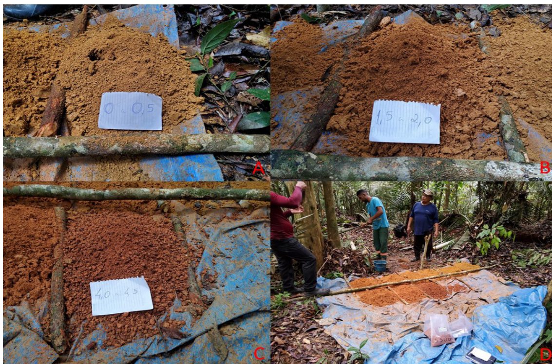
Figura 13 - Furo SSU-04. A) Solo silto-argilo-arenoso, amarelado, do início do perfil, similar ao encontrado nos furos anteriores B) Solo silto-areno-argiloso, avermelhado, entre 1,5 e 2,0m. C) Solo vermelho do intervalo 4,0 a 4,5m também demonstra semelhança com os intervalos finais dos furos anteriores. D) Todas as amostras dispostas no final da perfuração.
