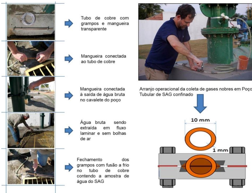
FIGURA 6 – Fluxograma dos procedimentos operacionais para a amostragem de água subterrânea para análise de GN. Extraído de KIRCHHEIM (2021). SAG: Sistema Aquífero Guarani.
