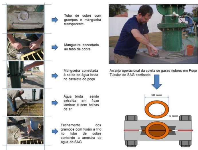
Figura 2. Fluxograma dos procedimentos operacionais para a amostragem de água subterrânea para análise de GN.
