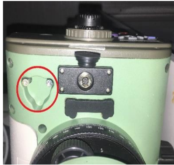
Figura 34 – Parafusos de retificação
