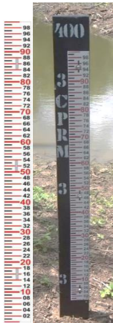
Figura 12 – Régua linimétrica padrão
