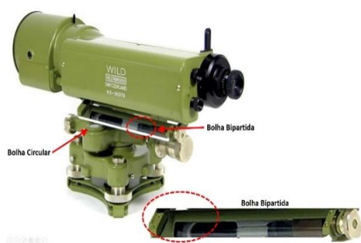
Figura 18 – Nível topográfico com bolha bipartida
