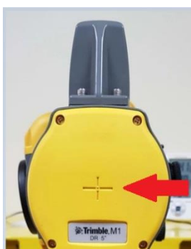
Figura 15 - Local para medição da altura
