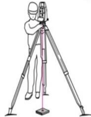
Figura 11 - Uso do Prumo da Estação Total
