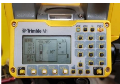
Figura 14 - Nivelamento da bolha tubular
