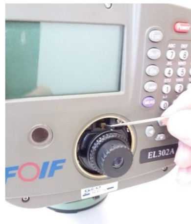
Figura 39 – Parafuso de retificação ótica
