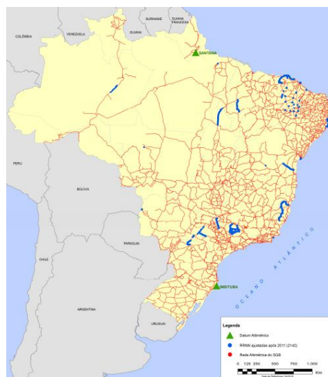
Figura 11 - Rede altimétrica de alta precisão (Fonte: IBGE, 2018)
