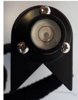
Figura 25 – Parafusos calantes no nível de cantoneira
