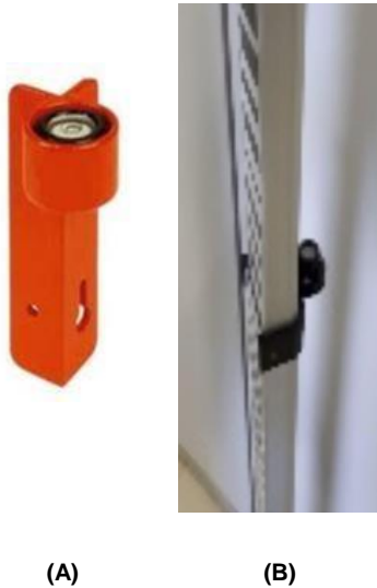
Figura 23 – (A) Nível de cantoneira independente e (B) Nível de cantoneira fixo na mira graduada
